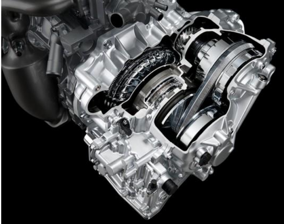
Slika 3 - Remenski varijator ugrađen u Nissan Murano
