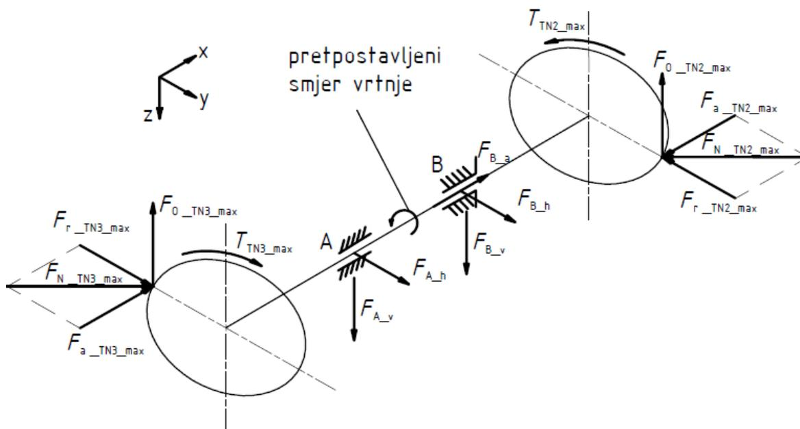
Slika 13 – Prostorni prikaz opterećenje međuvratila V
