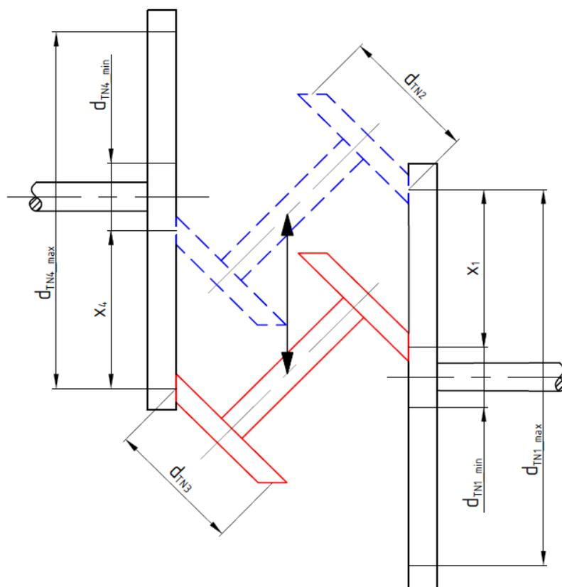
Slika 8 - Geometrija prijenosnika i kinematski promjeri
