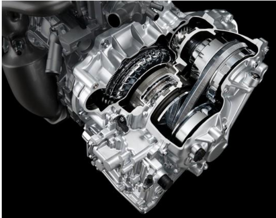
Slika 3 - Remenski varijator ugrađen u Nissan Murano
