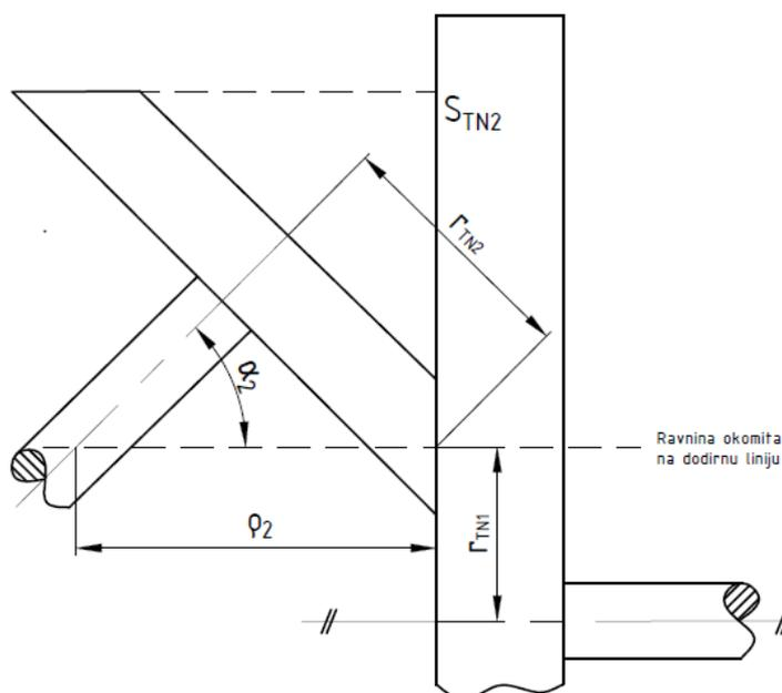
Slika 11 - Ekvivalentni polumjer zakrivljenosti tarenica TN<sub>2</sub> i TN<sub>1</sub>
