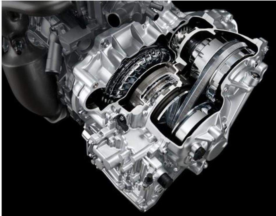
Slika 3 - Remenski varijator ugrađen u Nissan Murano
