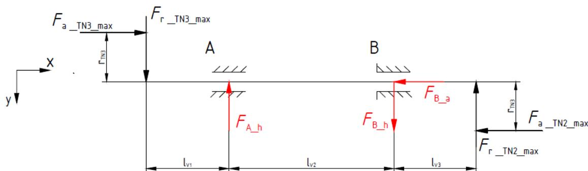
Slika 14 - Opterećenje međuvratila V u x - y ravnini
