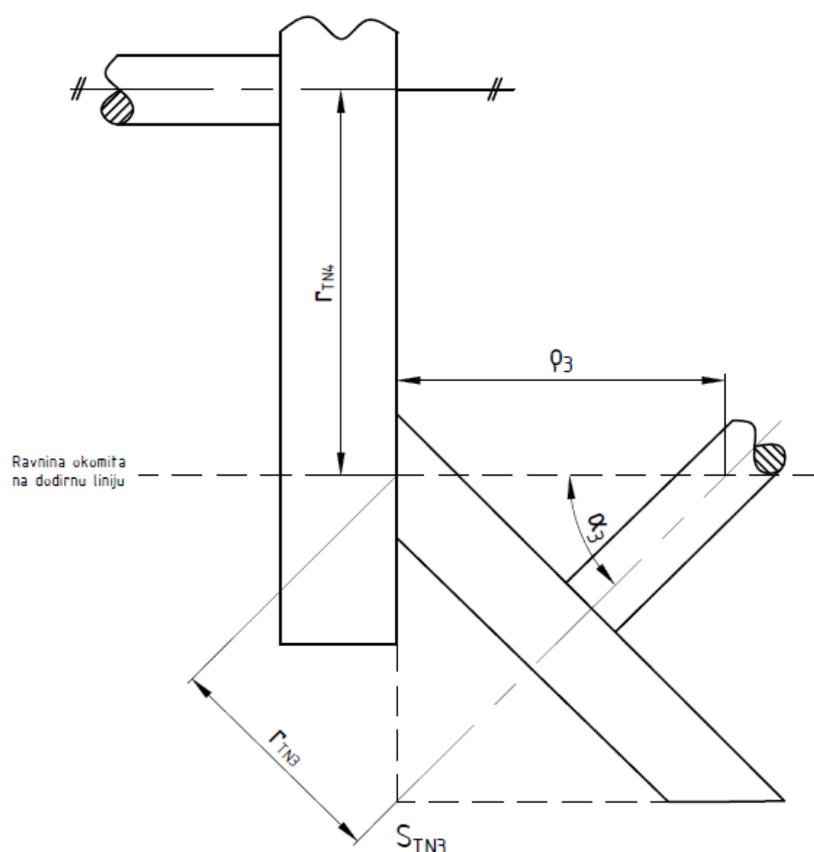
Slika 9- Određivanje ekvivalentnog polumjera zakrivljenosti za tarni par TN<sub>4</sub> i TN<sub>3</sub>
