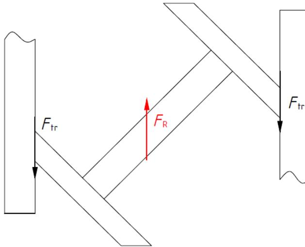
Slika 20 - Potrebna rezultantna sila za pomicanje
