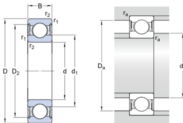
Slika 18 - Dimenzije valjnog ležaja 6207 - 2RS1
