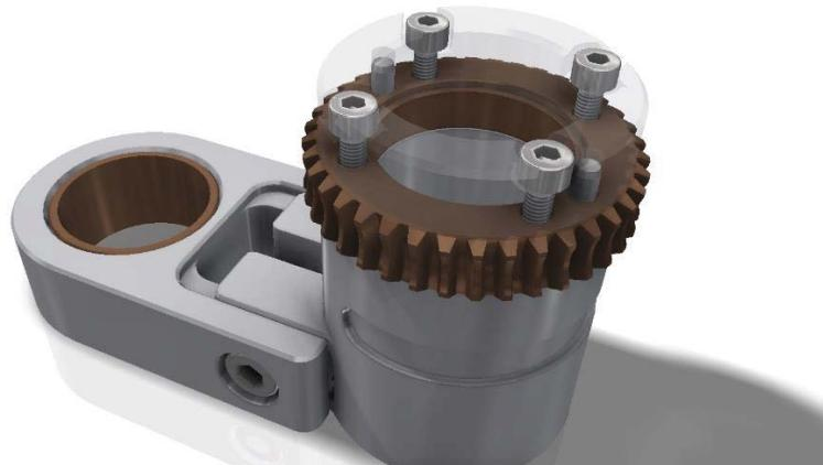
Slika 25. Prihvati i pozicioniranje pužnog kola na sklop čeljusti za rotaciju
