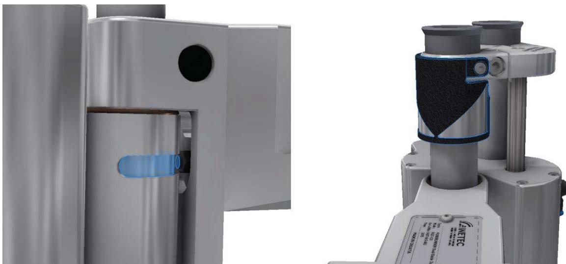
**Slika 14. Sustav za kalibraciju položaja alata**
