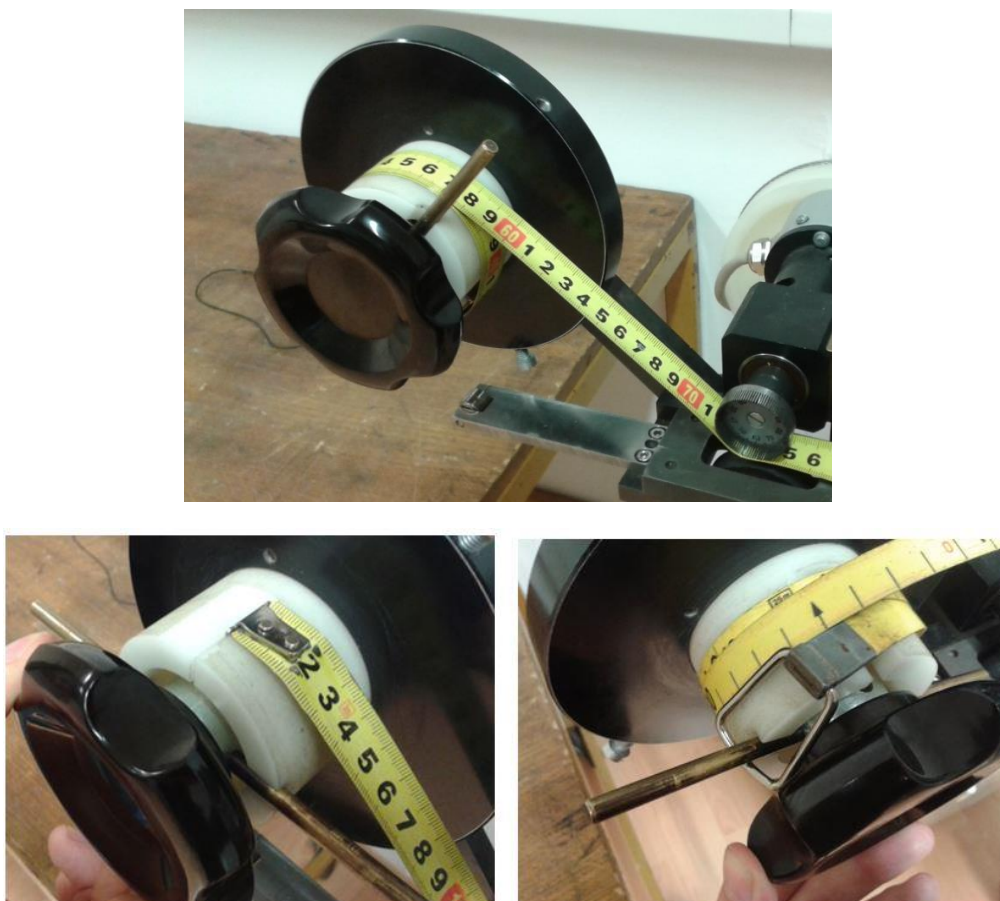
Slika 4: Prihvat različitih početaka mjernih traka na bubanj
