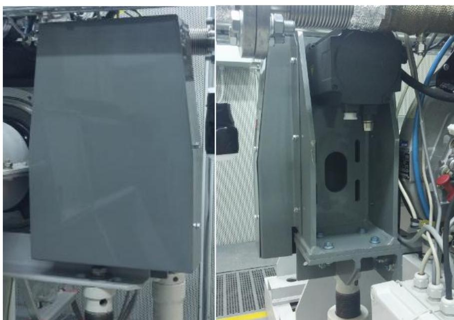
*Slika 30. Nosiva konstrukcija sa zaštinim limovima i elektromotorom*
