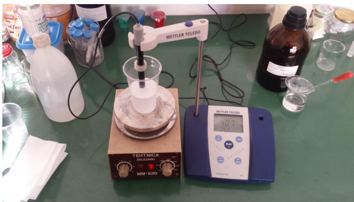
Slika 19. Mjerenje pH-vrijednosti suspenzije
