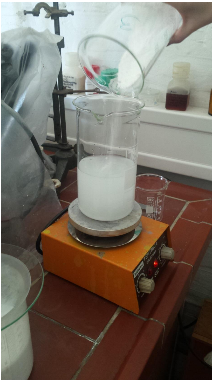
Slika 18. Priprema suspenzije sa vodom, i miješanje na elektromagnetskoj mješalici
