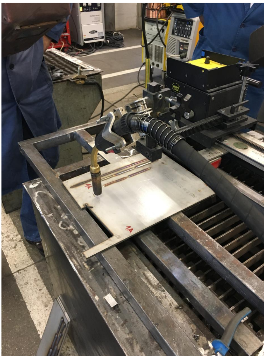
Slika 21 Postav eksperimenta za navarivanje
