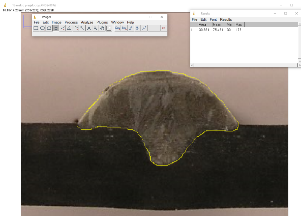
Slika 31 Mjerenje penetracije pomoću programa ImageJ
