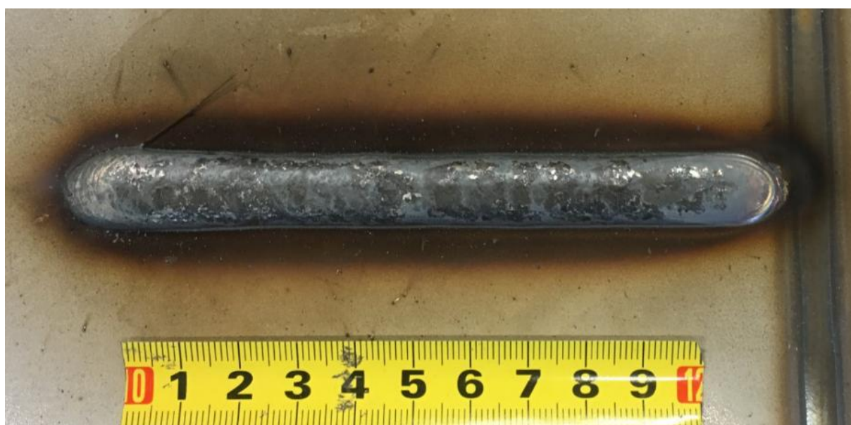
Slika 25 Rezultat navarivanja uzorka 2B
