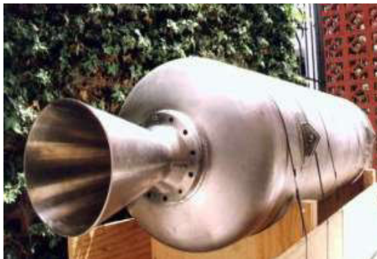
Slika 30 – Kućište raketnog motora izrađeno od visokolegiranog Cr-Ni čelika
