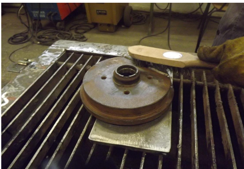
Slika 40. Čišćenje zavara čeličnom četkom
