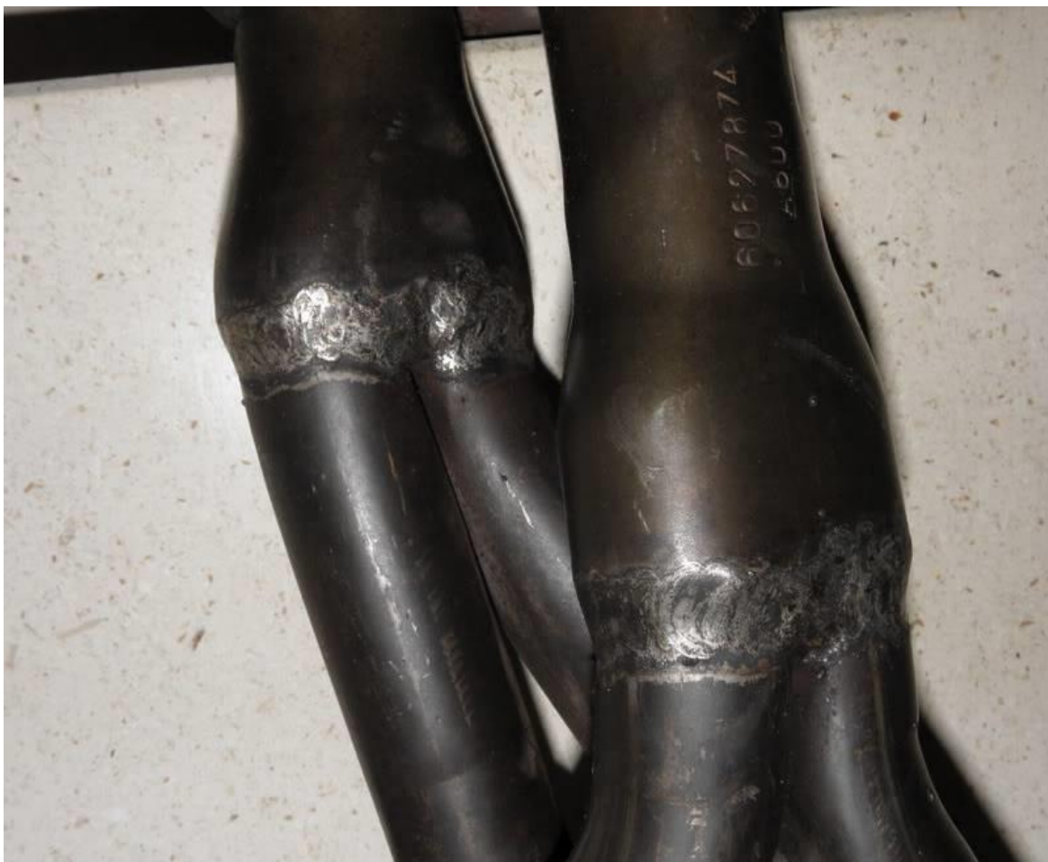
Slika 10. Ispušna grana ventila motora zavarena na toplo [10]
