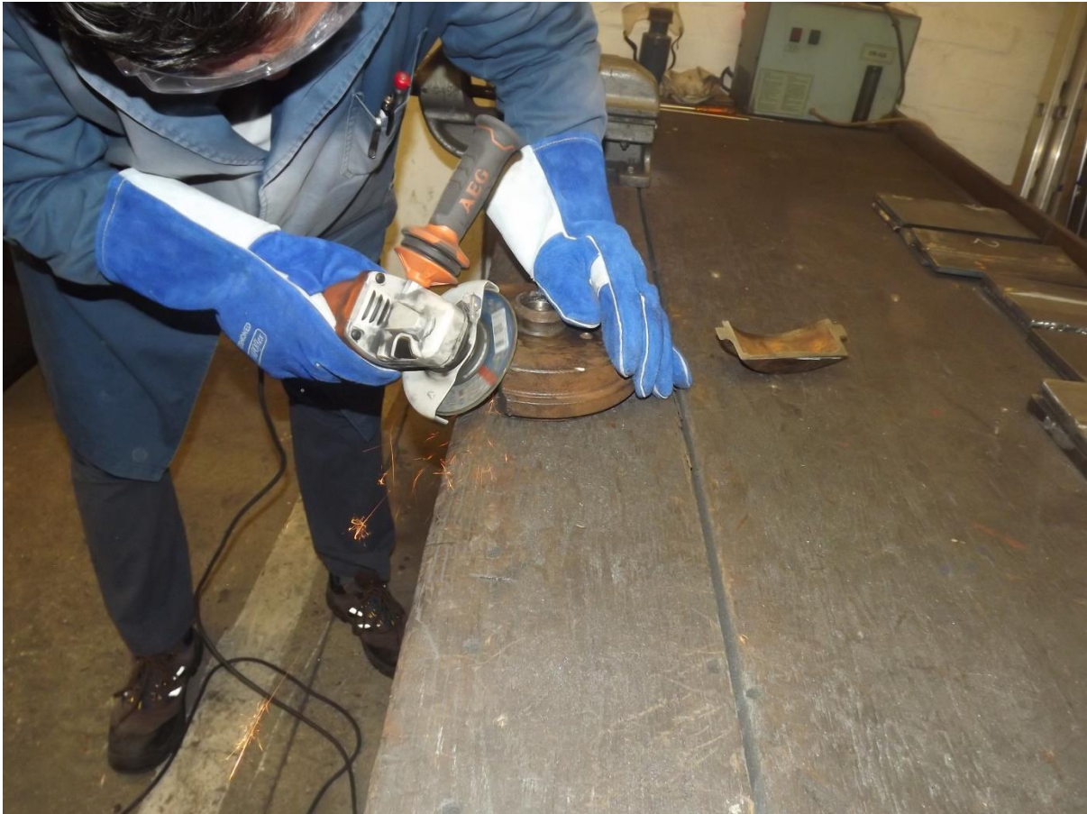
Slika 32. Priprema žlijeba kutnom brusilicom
