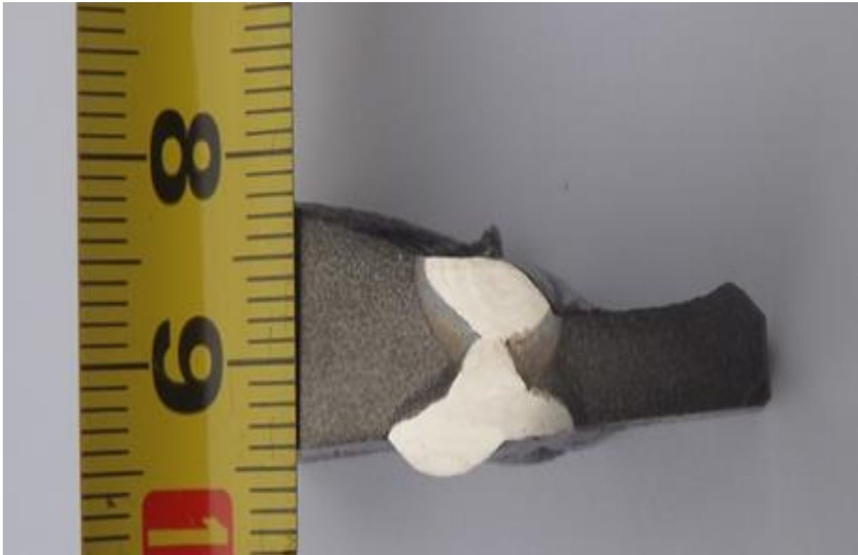
Slika 51. Makroizbrusak nakon uranjanja u nital
