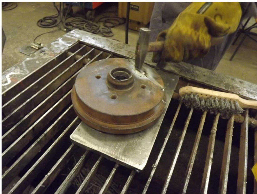
Slika 39. Raskivanje zavara čekićem
