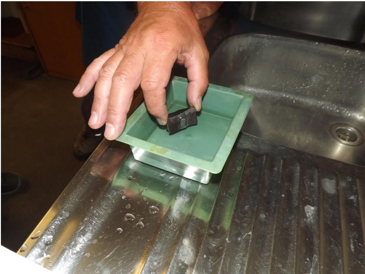
Slika 50. Uranjane makroizbruska u otopinu nital
