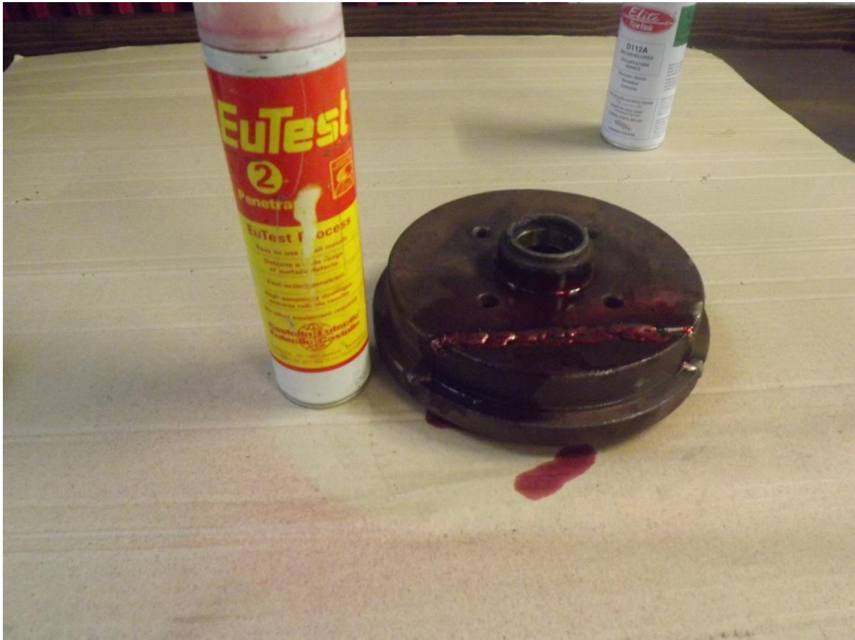
Slika 46. Penetriranje radnog komada
