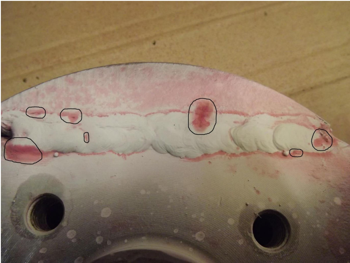
Slika 47. Radni komad nakon ispitivanja penetrantskom metodom
