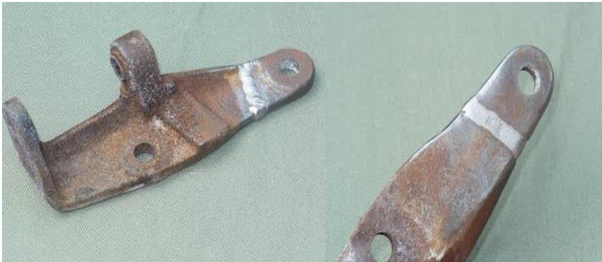
Slika 17. Držač zavaren na hladno [16]
