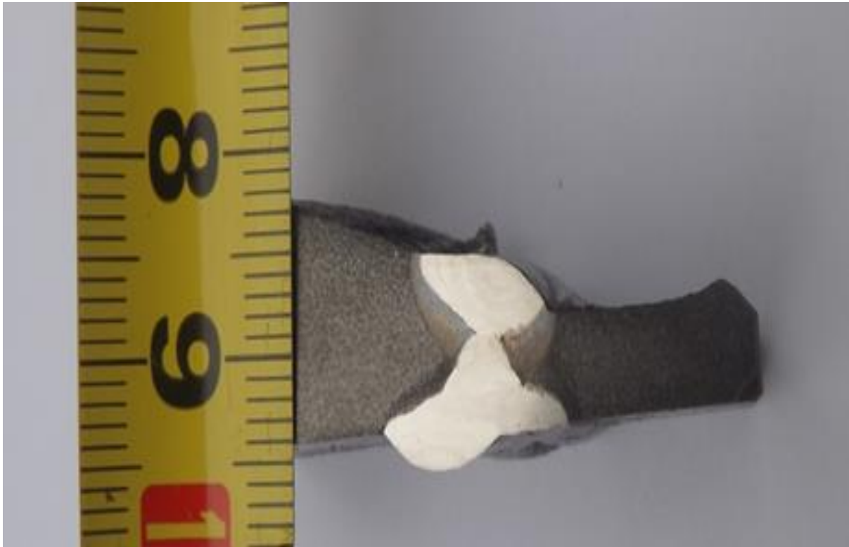
Slika 51. Makroizbrusak nakon uranjanja u nital
