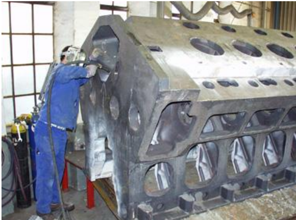
Slika 19. Blok motora zavaren na hladno [16]
