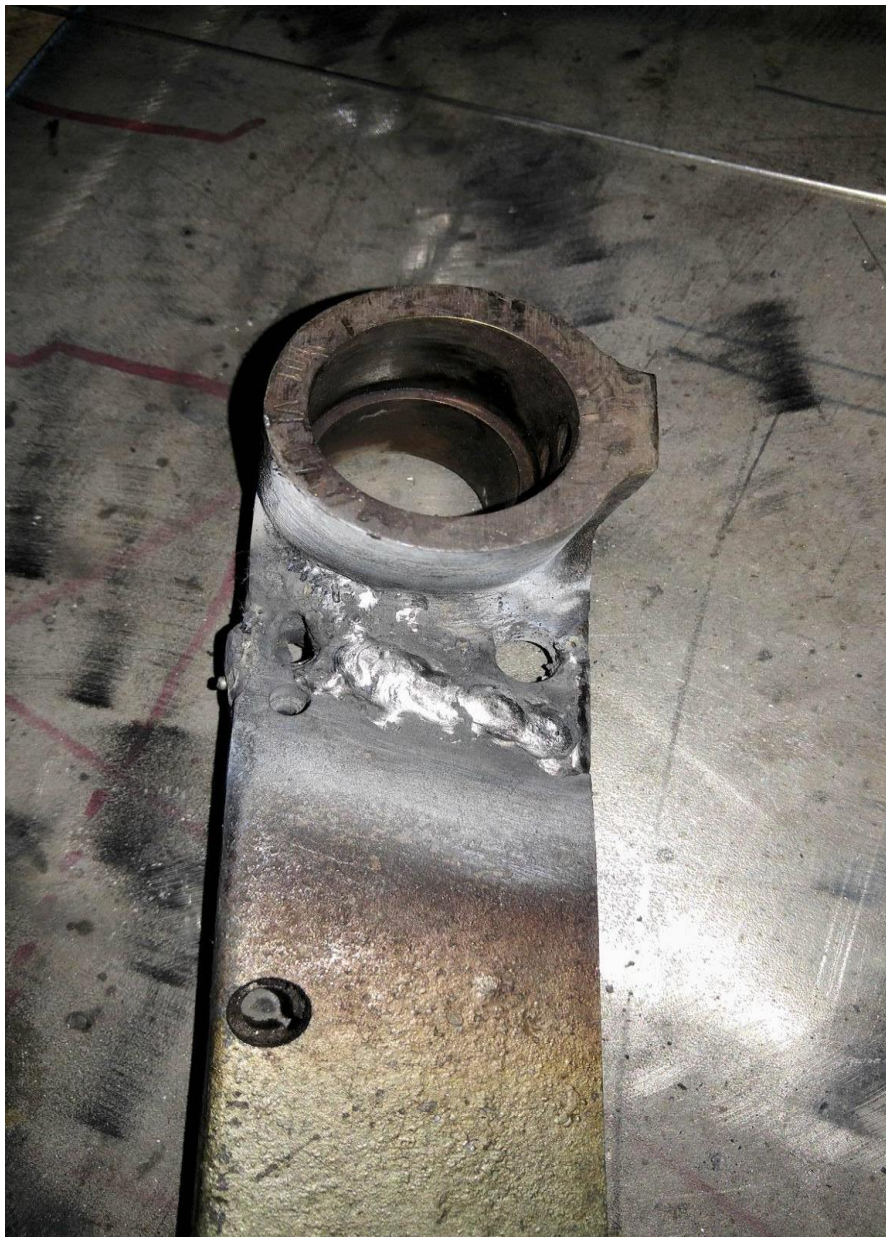
Slika 8. Zavareni nosač poluge [10]
