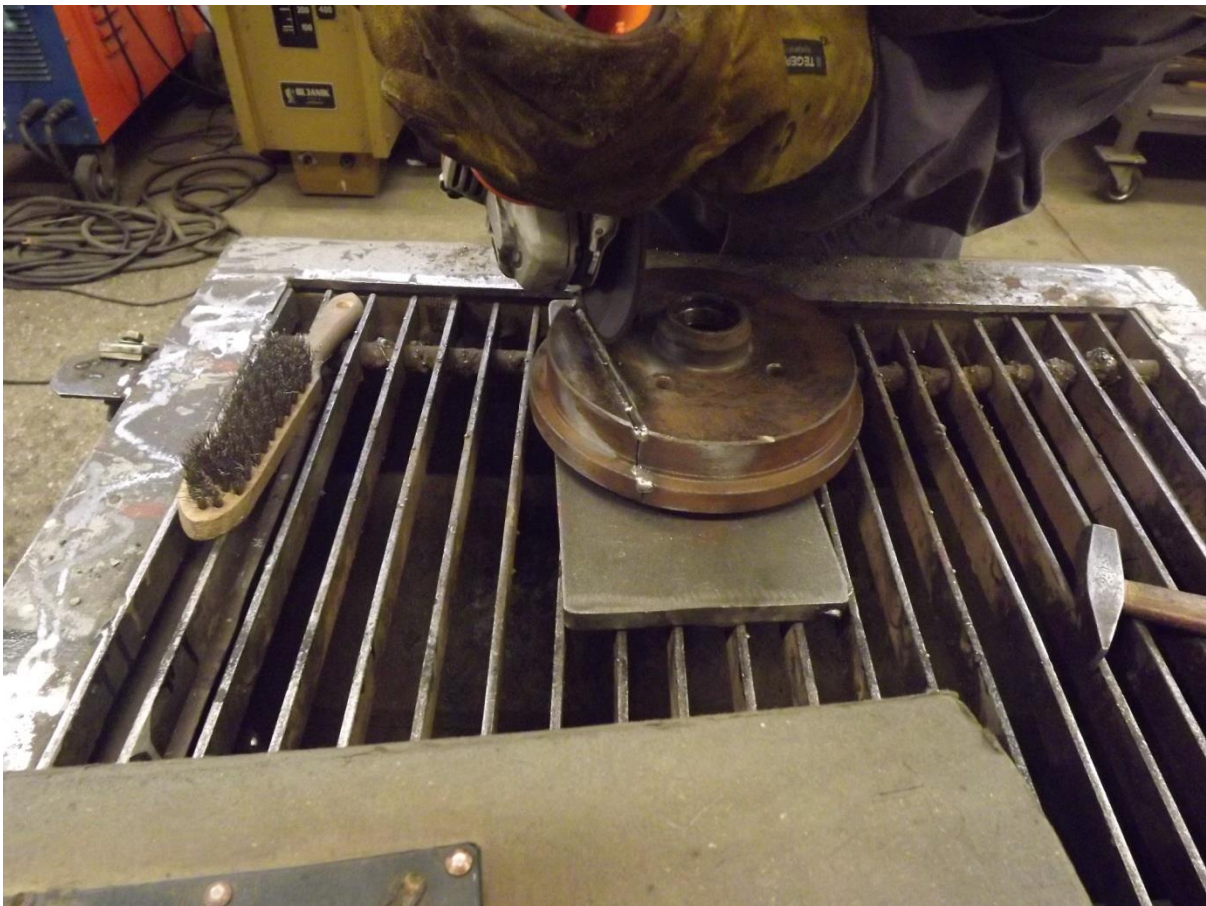
Slika 41. Uklanjanje troske kutnom brusilicom
