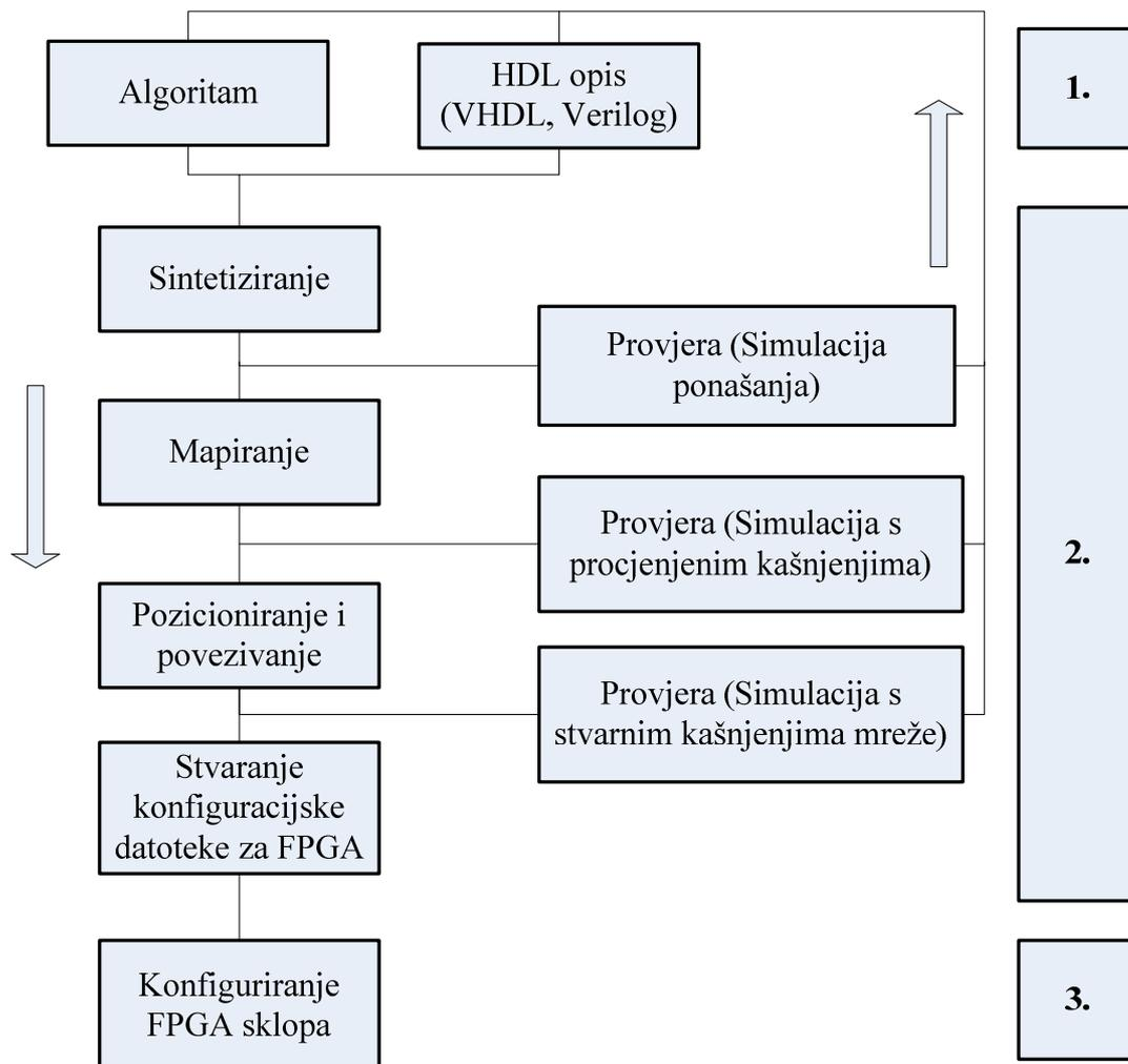
**Slika 34. Koraci sinteze, konfiguracije i programiranja FPGA**
