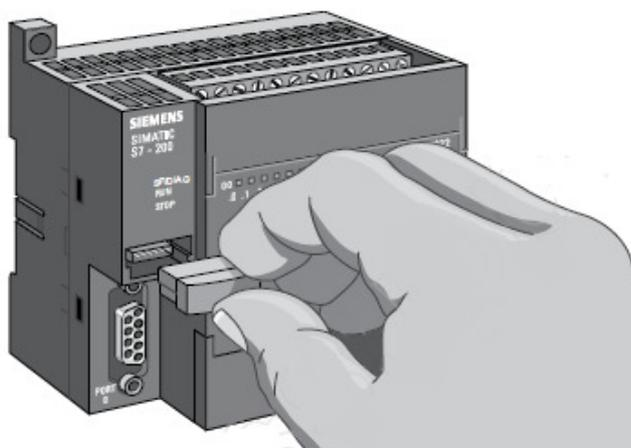
Slika 28. Ulaz za nadogradnju PLC-a
