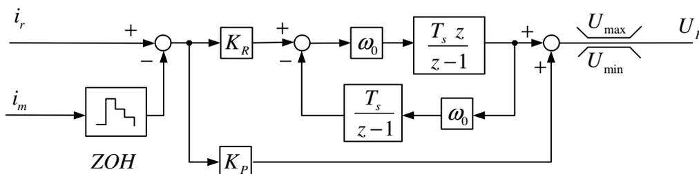
Slika 9. Simulacijski blok PR regulatora - vremenski-diskretni slučaj
