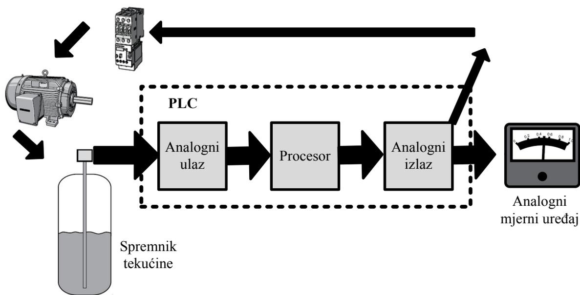
Slika 22. Primjer kruga sa analognim ulazima i izlazima
