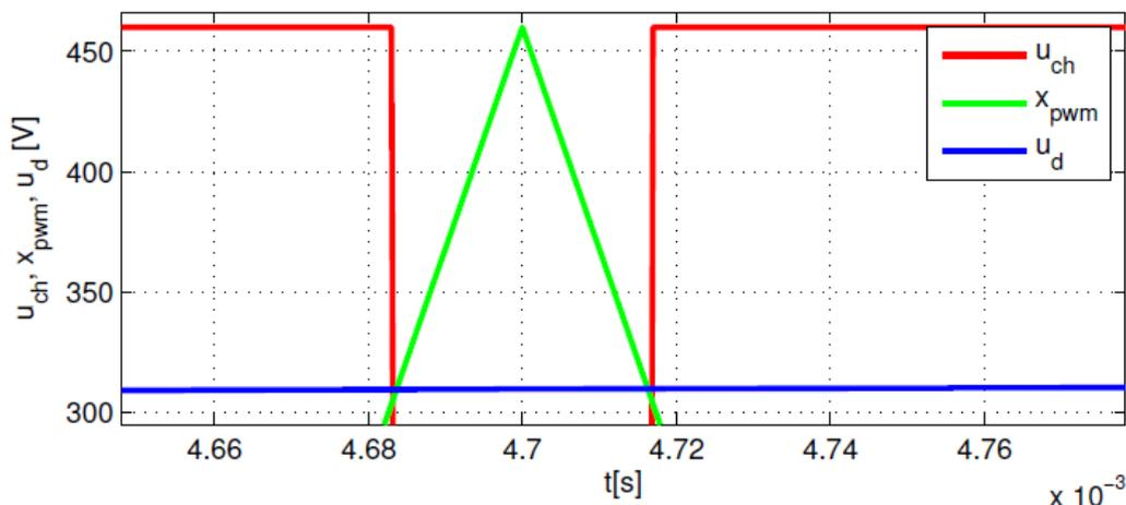
Slika 13. Detalj generiranja PWM signala za sinusnu referencu
