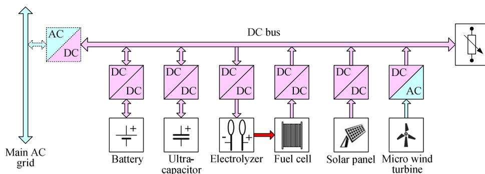
**Slika 1. Topologija istosmjerne mikromreže sa više upravljivih izvora i sustava a pohranu energije i spojem izmjenjivača na AC mrežu**
