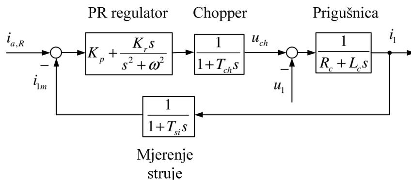
Slika 4. Blok dijagram regulacijskog kruga struje
