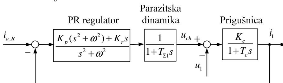
**Slika 5. Pojednostavljeni sustav regulacije struje**
