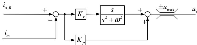
Slika 7. Simulacijski blok PR regulatora
