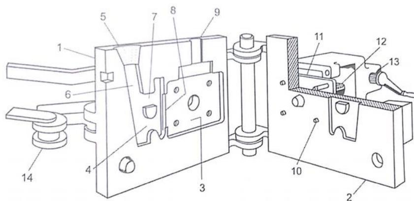
Ručni kalup za lijevanje kokilnog lijeva [1]
