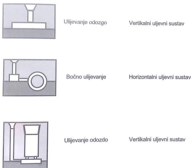
Slika 10. Uljevni sustavi u odnosu na razdjelnicu [1]
