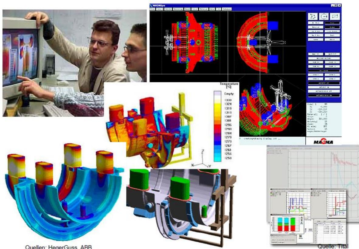
Slika 19. Simulacije lijevanja [12]
