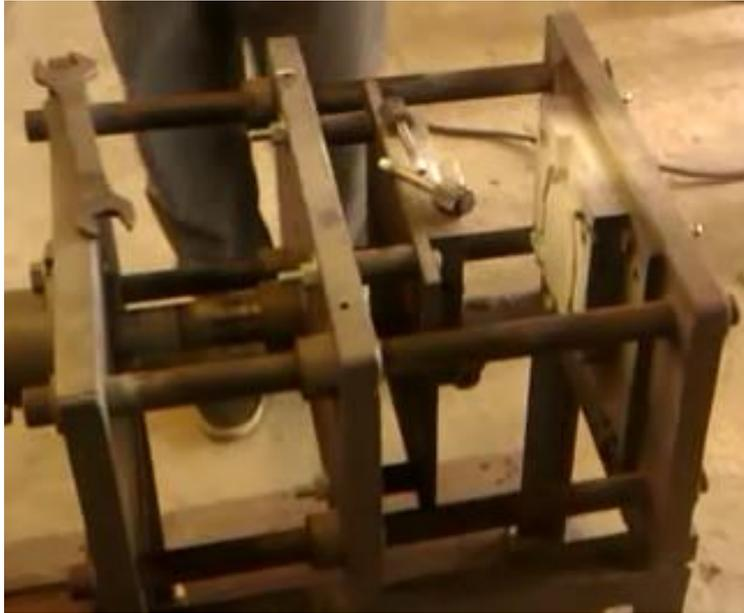
Slika 54. Otvaranje kokile nakon lijevanja
