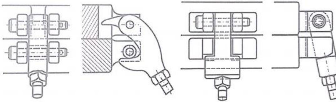
Slika 7. Načini stezanja kalupa: lijevo – ručno; desno – automatizirano [1]
