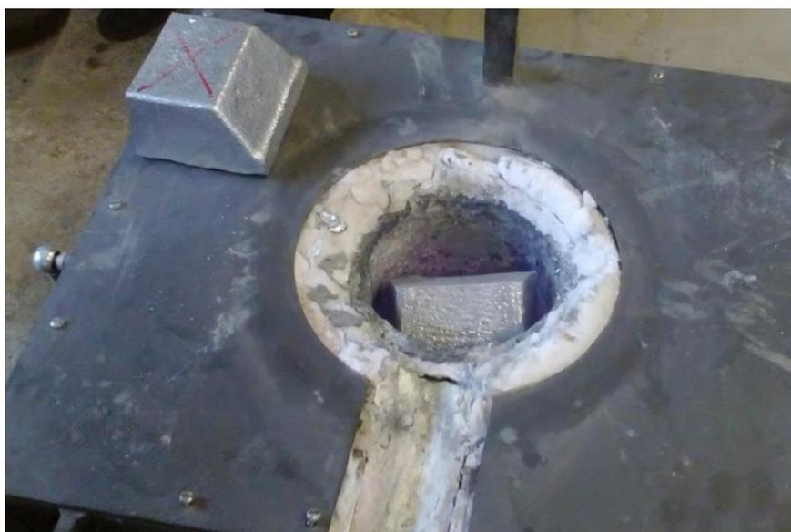
Slika 45. Taljenje aluminijskih ingota
