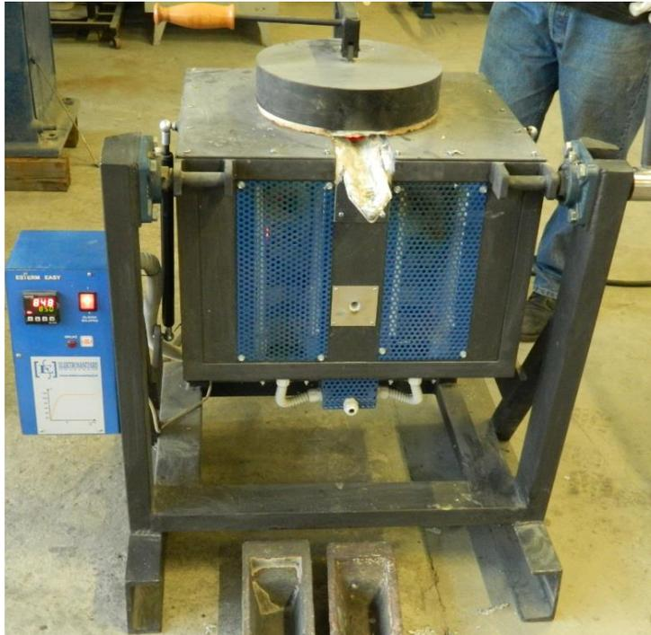
Slika 44. Elektrootporna peč za taljenje
