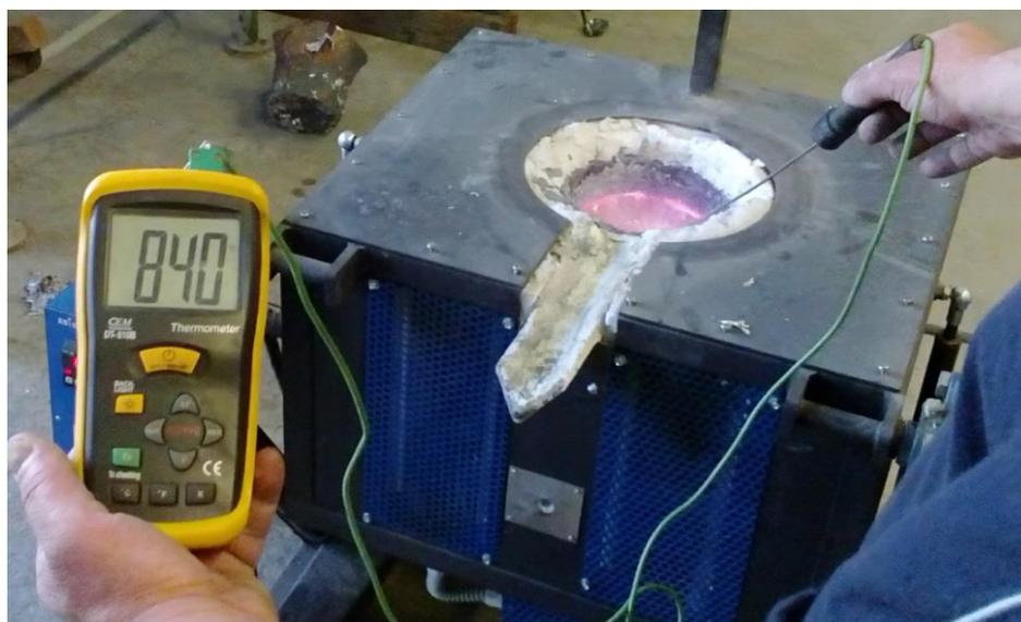
Slika 47. Mjerenje temperature taljevine
