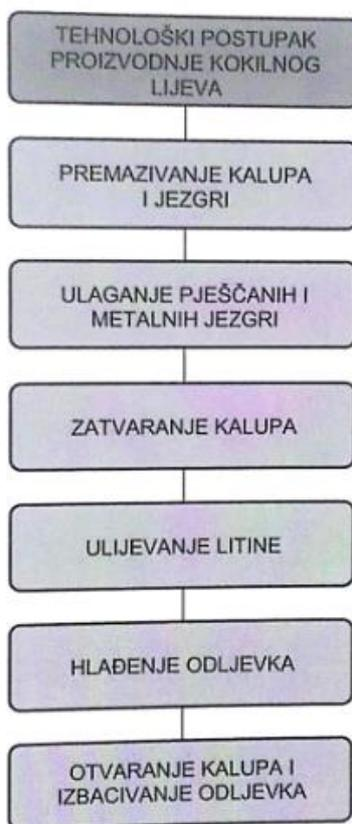
Slika 4. Tehnološki postupak proizvodnje kokilnog lijeva [1]
