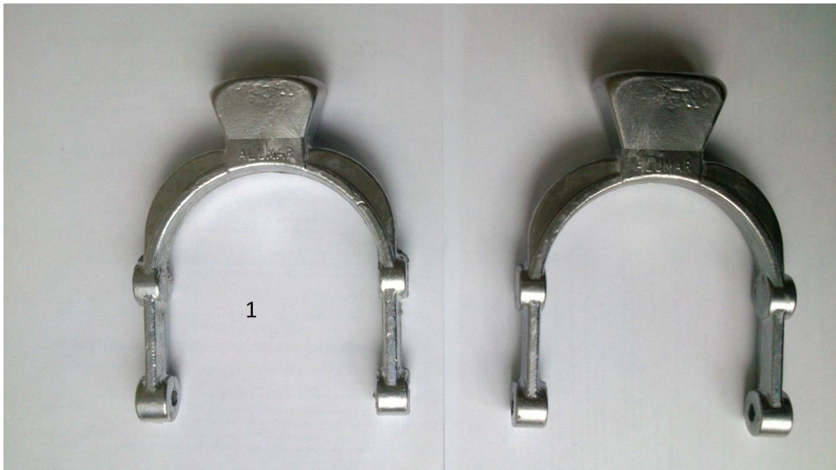
Slika 59. Prvi odljevak- hladniji kalup (lijevo) i topliji kalup (desno)
