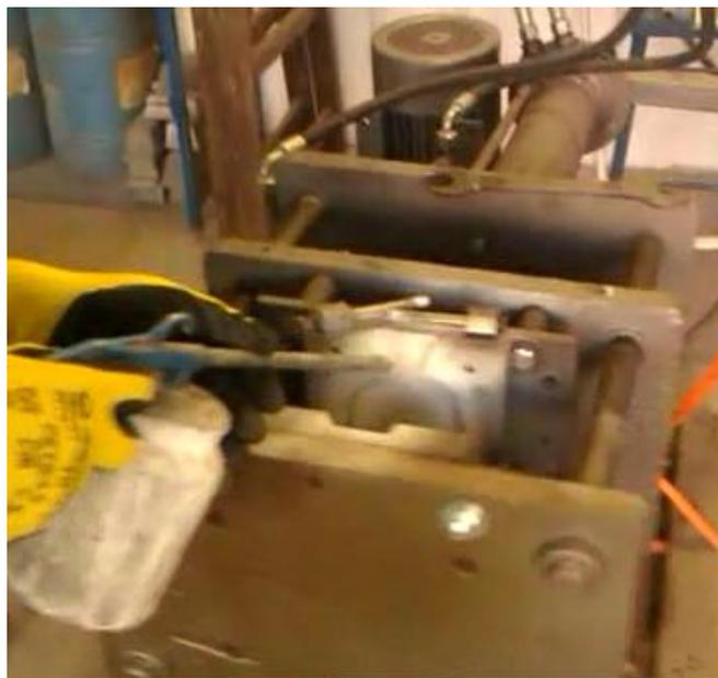
Slika 52. Nanošenje premaza na kokilu
