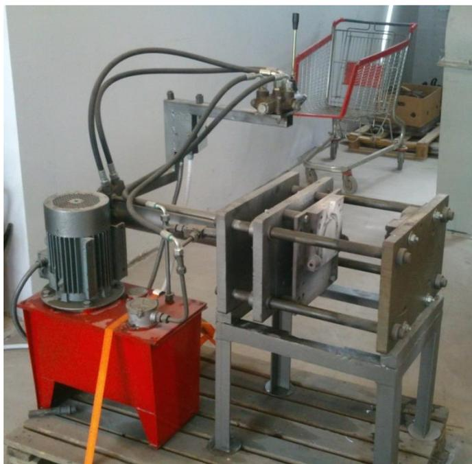
Slika 48. Kokilni stroj za lijevanje, otvoren kalup
