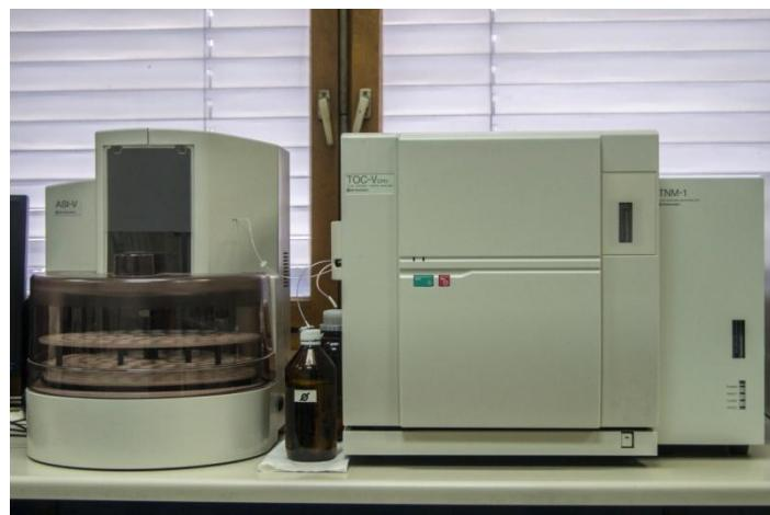
Slika 22. Uređaj za mjerjenje vrijednosti NPOC-a (TOC-a)
