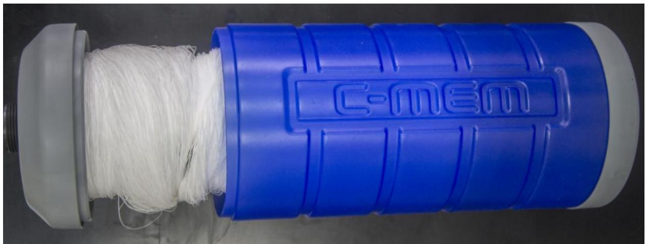
Slika 13. C-mem vakuumska membrana
