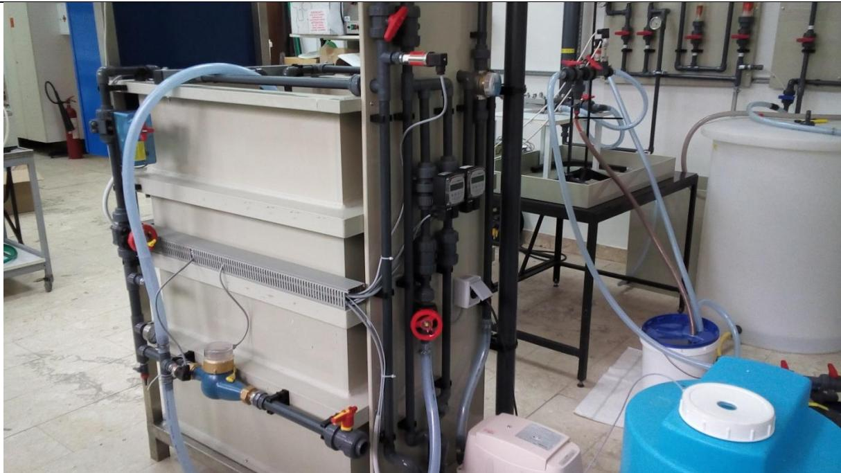
Slika 11. Laboratorijski uređaj sa UF/MF vakuumskom membranom
