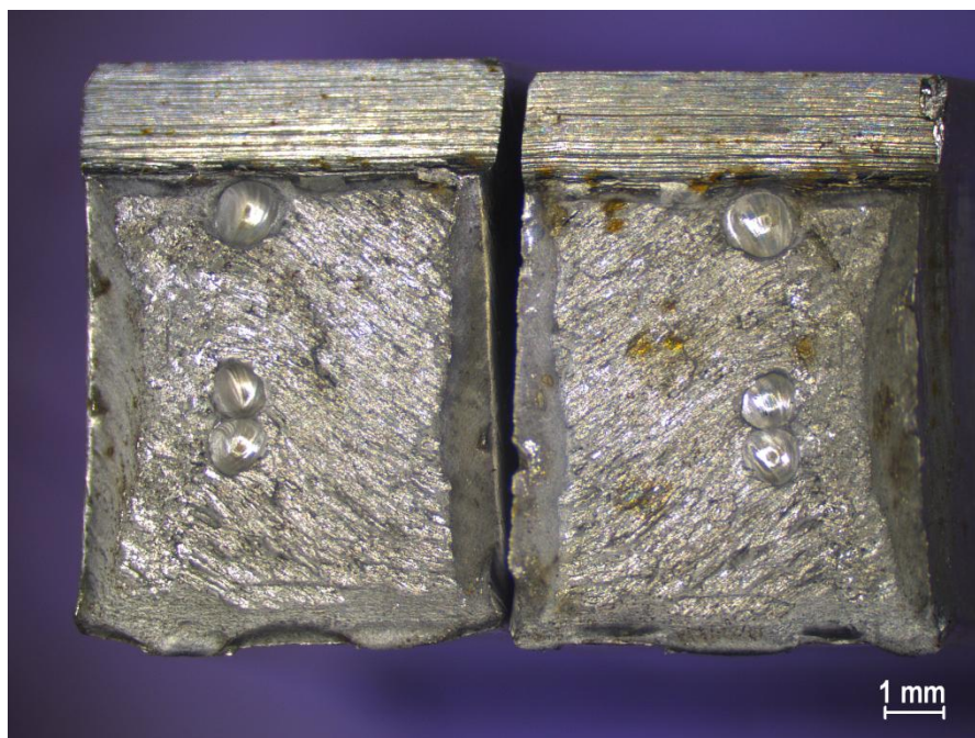
Slika 53. Poroznost u metalu zavara; stanje pokusa 8; KV=24,5 J
