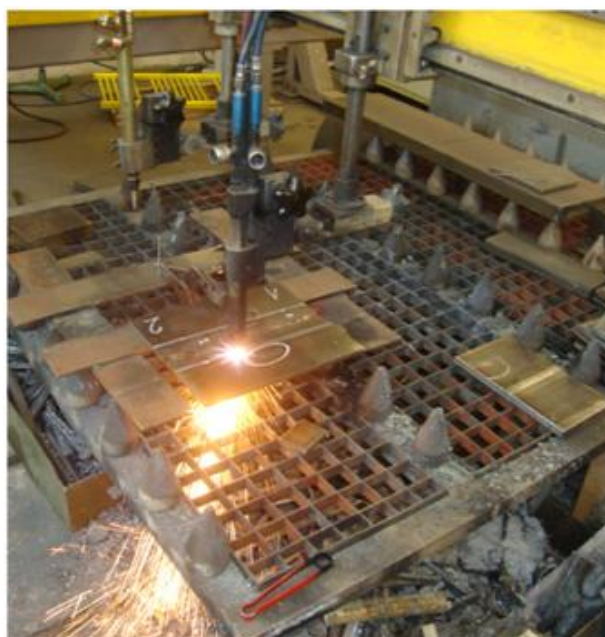
Slika 44. Izrezivanje ploča plinskim postupkom
