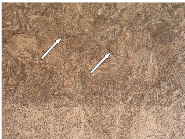
Slika 10. Pukotina u grubozrnatom ZUT-u, povećanje 500x [14]
