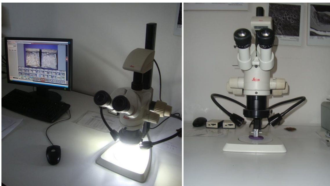
Slika 51. Stereo mikroskop LEICA MZ6
