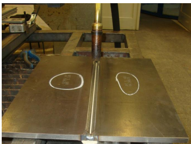
Slika 41. Ploča spremna za zavarivanje
