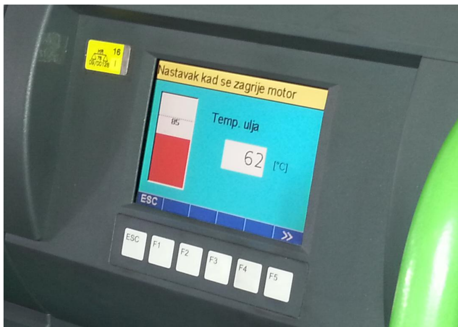
Slika 29. Zagrijavanje motora, odnosno katalizatora na radnu temperaturu
