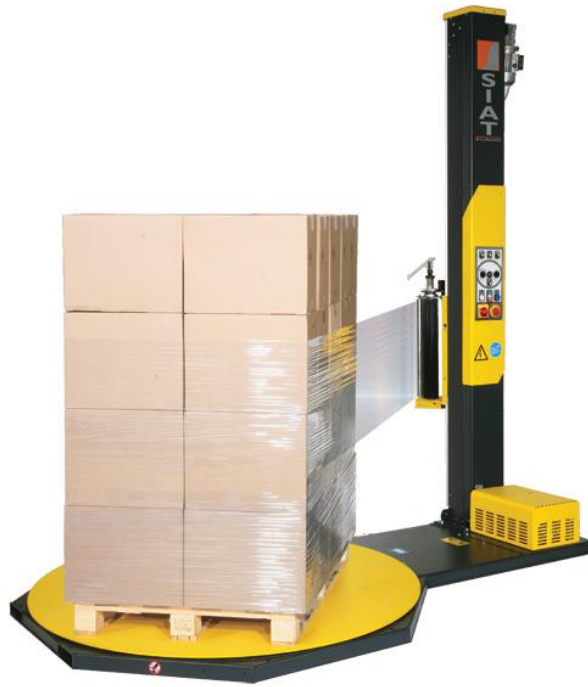
Slika 31. Stroj za omatanje palete "stretch" folijom [15]
