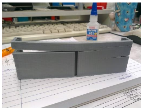
Slika 3.5. Premalo kvašenje između slojeva [13]
