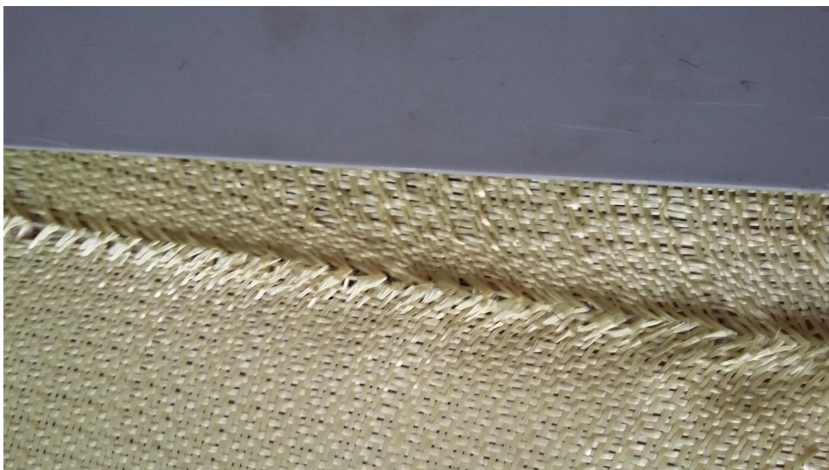
Slika 7.1. Krojenje aramidnih vlakana
