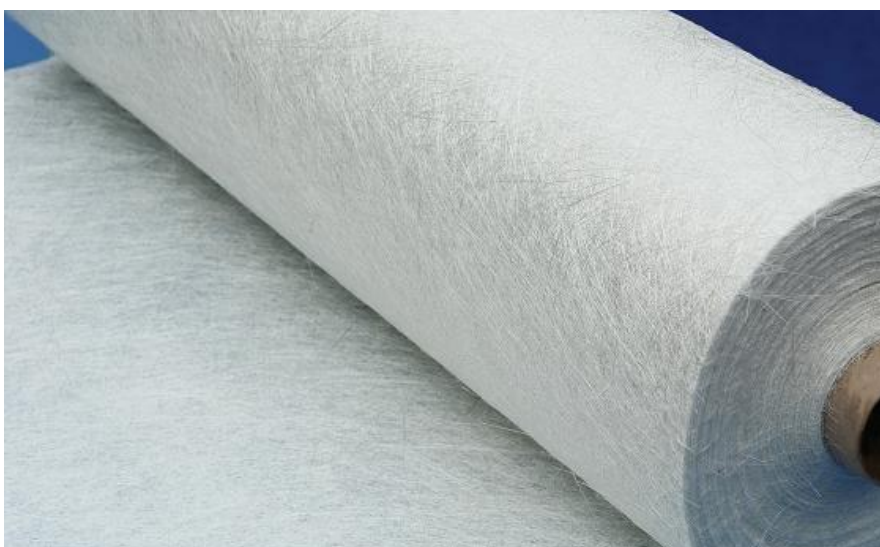
Slika 2.4. Staklena vlakna u obliku mata [10]
