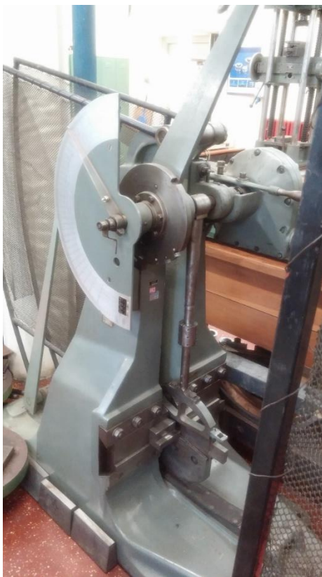
Slika 6.6. Charpyev bat AVK Budapest UT300
