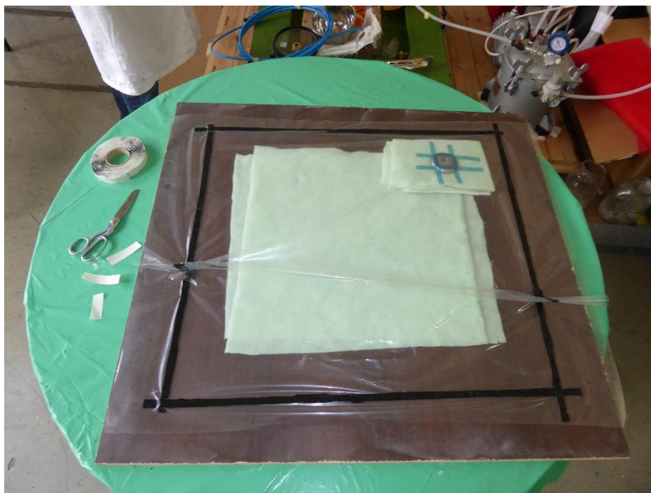
Slika 7.10. Hermetički zatvoren kalup pomoću folije od poliamida
