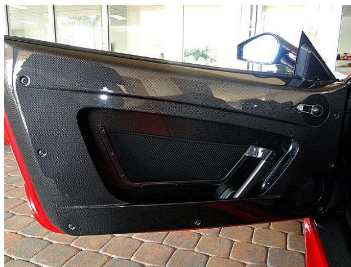
Slika 4.7. Panel vrata izrađen od matrice ojačane ugljikovim vlaknima [78]
