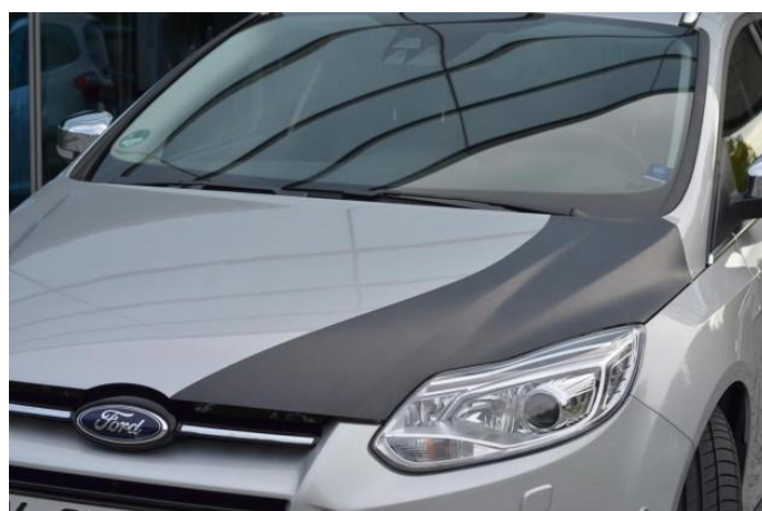
Slika 4.5. Fordov poklopac motora ojačan ugljikovim vlaknima [75]
