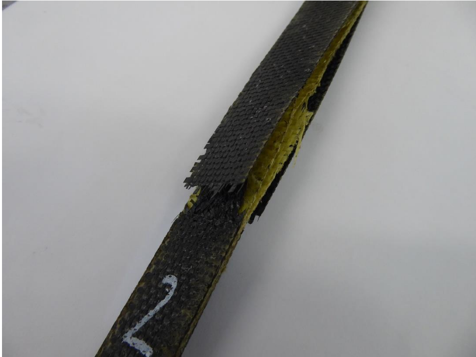
Slika 8.5. Raslojavanje ispitnog tijela
