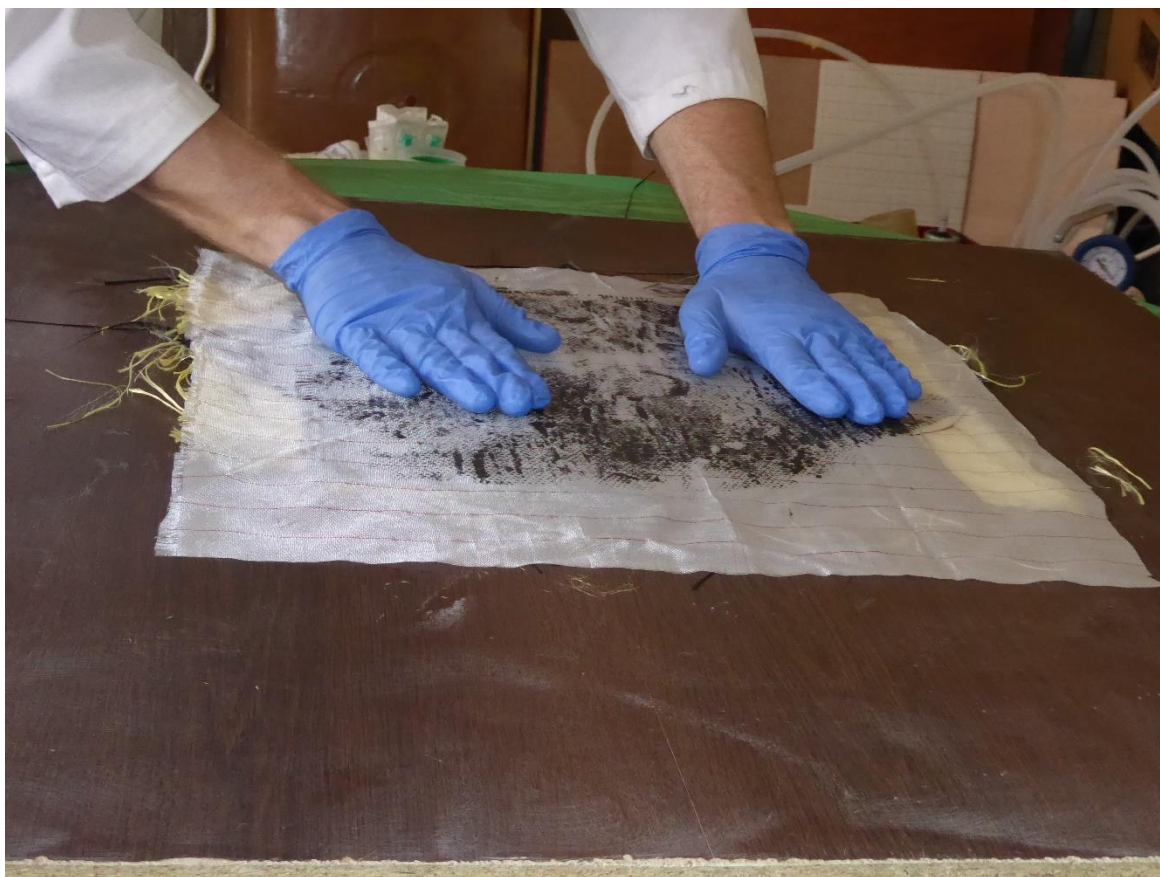
Slika 7.8. Postavljanje tkanine za odjeljivanje
