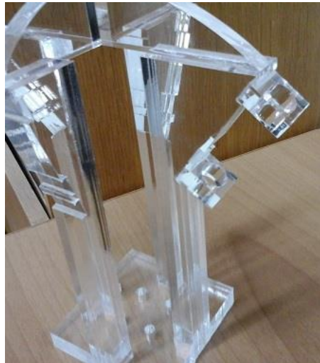
Slika 36 Postupak sklapanja T-fantoma; lijepljenje pločica na nagibe.
