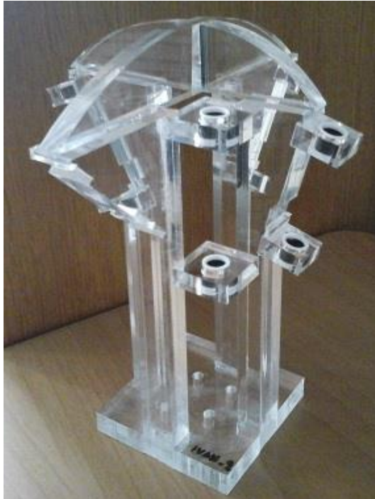
Slika 38 Postupak sklapanja T-fantoma; Postavljanje većih pločica između nagiba.
