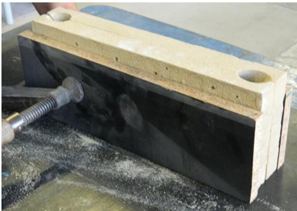
Slika 6.13. Kalup spremam za ulijevanje
