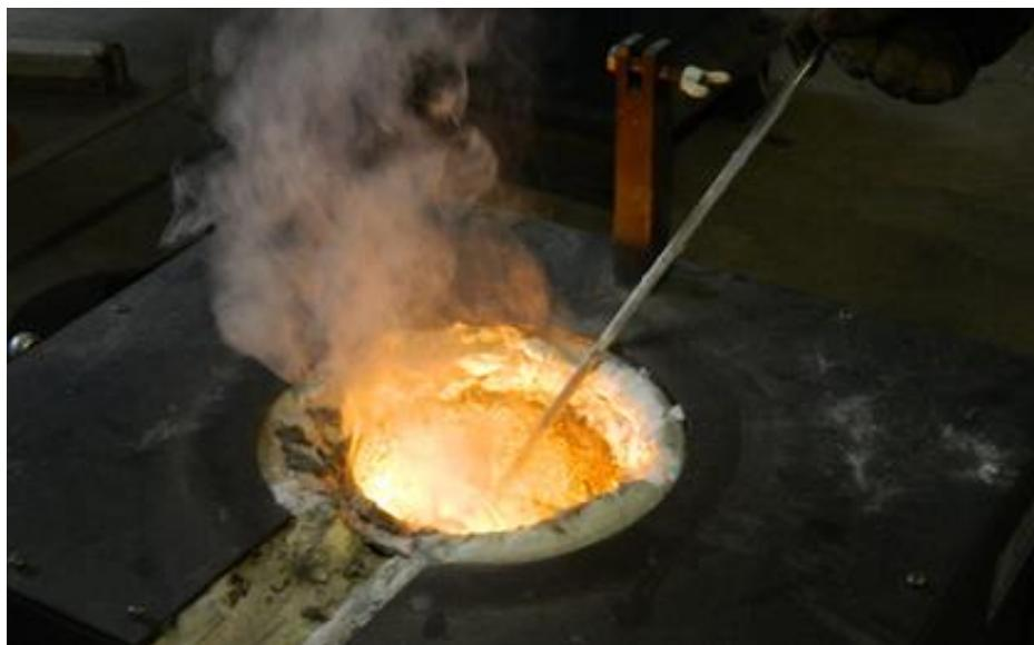
Slika 6.29. Ustanjanje modifikatora u taljevinu
