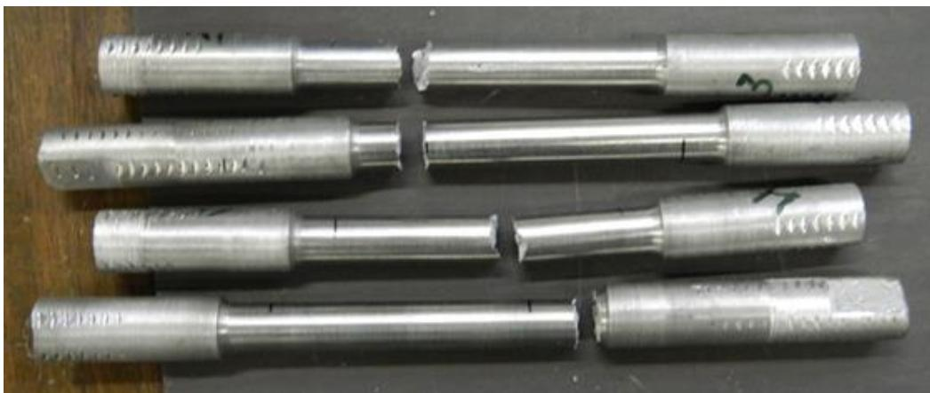
Slika 6.44. Epruvete nakon kidanja
