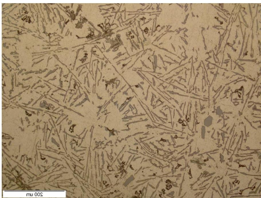
Slika 6.38. Struktura osnovne taljevine s udaljenosti 47,5mm od vrha stošca
