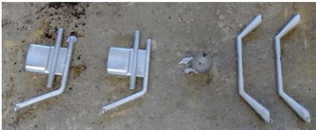
Slika 6.26. Gotovi odljevci nakon vađenja iz kalupa
