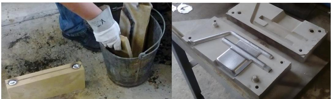
Slika 6.25. Vađenje odljevka iz kalupa vodeno staklo-CO<sub>2</sub> (lijevo), kokila (desno)
