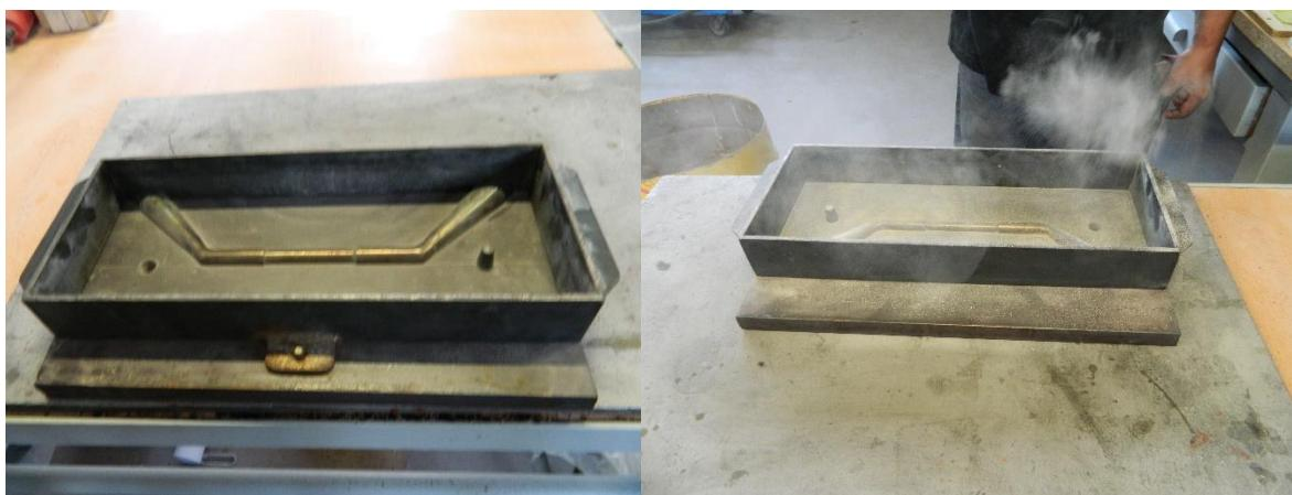
Slika 6.8. Kalupnik (lijevo), posipanje kalupnika likapodijem (desno)
