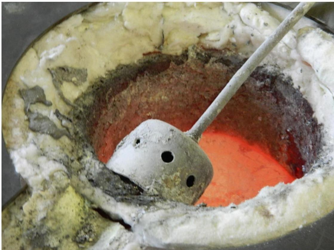
Slika 6.28. Grijanje modifikatora u zvonu za uranjanje
