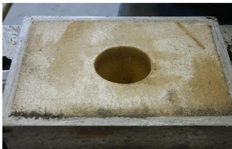
Slika 6.18. Kalup spremjan za ulijevanje
