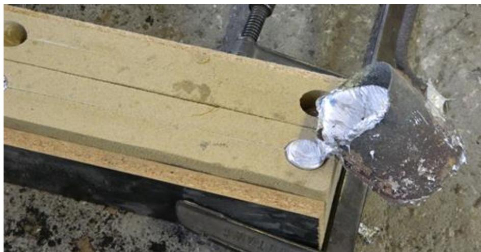
Slika 6.30. Uljevanje modificirane taljevine u kalup izrađen postupkom vodeno staklo-CO<sub>2</sub>
