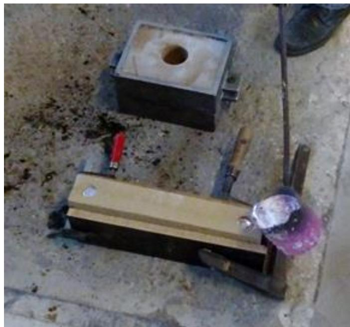
Slika 6.23. Lijevanje epruvete u kalup izrađen postupkom vodeno staklo-CO<sub>2</sub>
