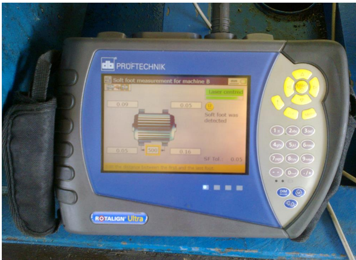
Slika 43. Postupak detekcije i otklanjanja „soft foot“
