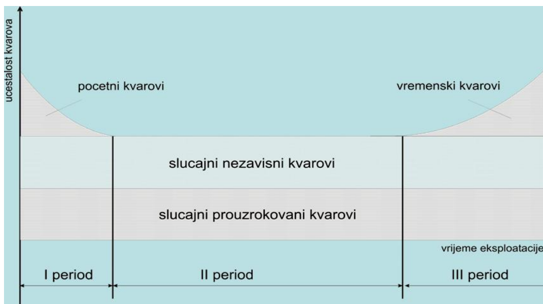
Slika 2. Učestalost kvarova tijekom životnog vijeka stroja [2]
