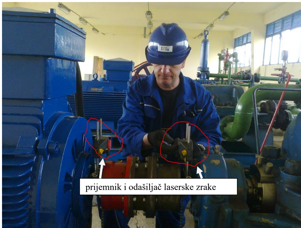
Slika 39. Montiranje prijemnika i odašiljača na vratila
