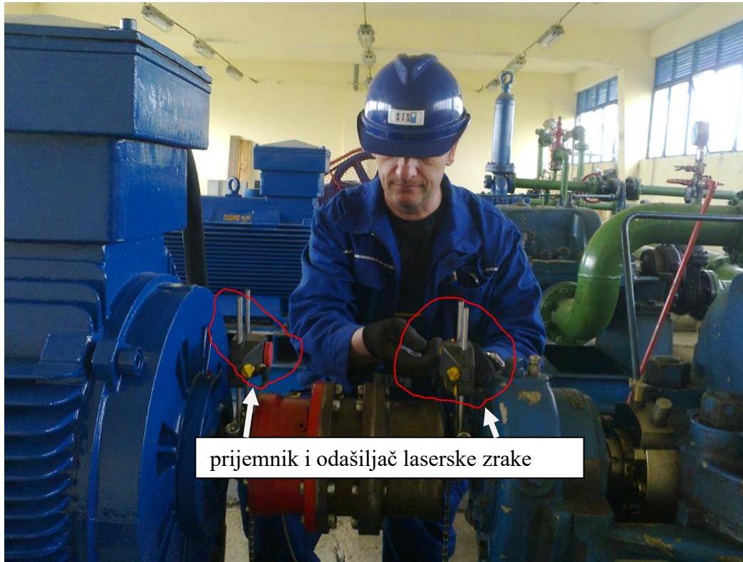
Slika 39. Montiranje prijemnika i odašiljača na vratila
