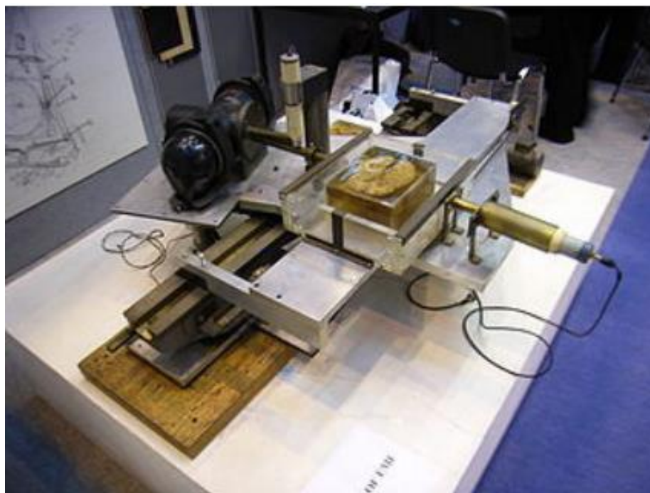
Slika 1. Prototip CT uređaja koji je razvio G. Hounsfield [8]
