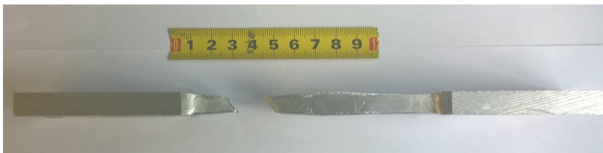
Slika 36. Uzorak A nakon statičkog vlačnog ispitivanja
