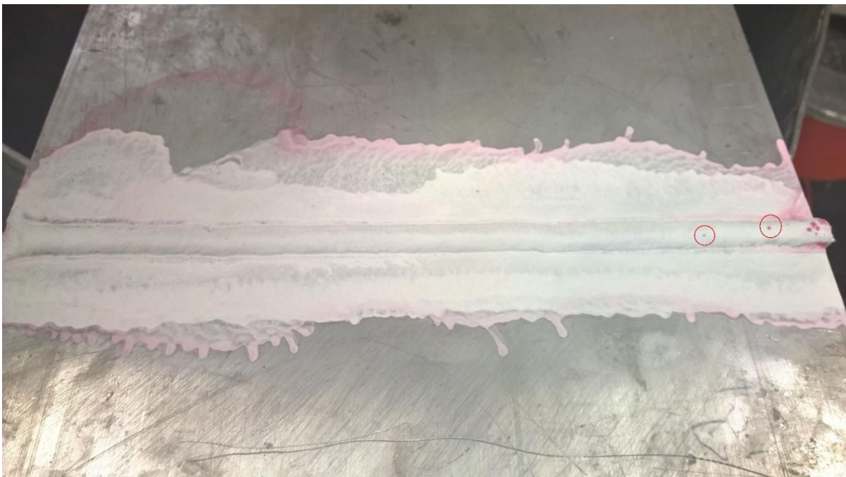
Slika 31. Korijen zavara uzorka B nakon ispitivanja penetrantima
