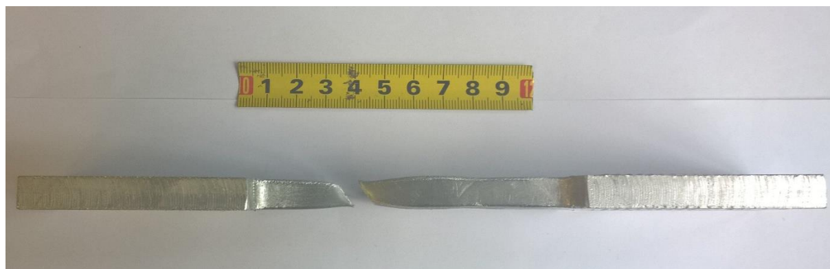
Slika 38. Uzorak B nakon statičkog vlačnog ispitivanja
