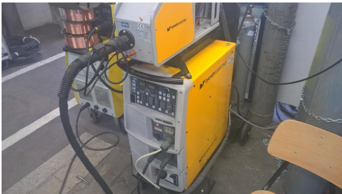
Slika 21. Izvor struje za zavarivanje Welbee P400 u Laboratoriju za zavarivanje FSB
