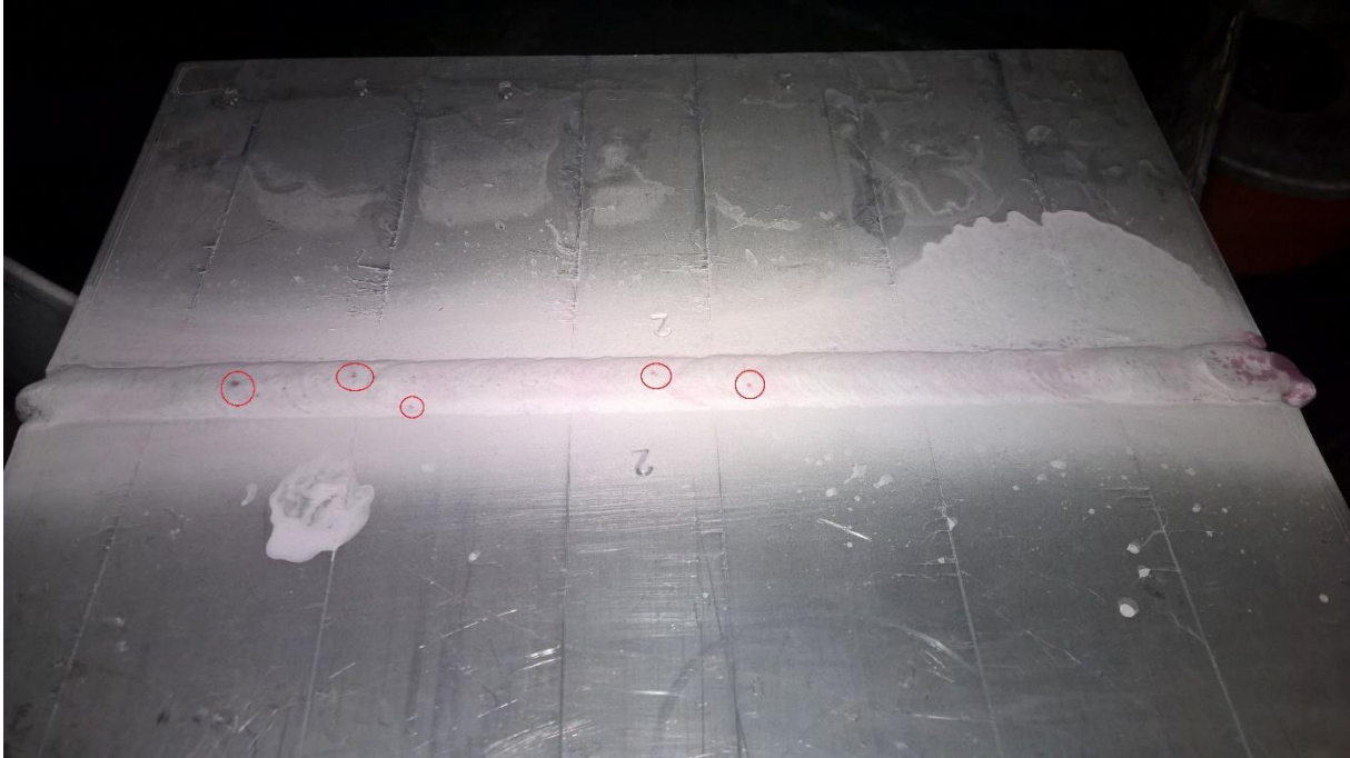
Slika 30. Lice zavara uzorka B nakon ispitivanja penetrantima
