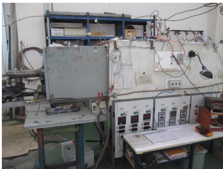
Slika 21. Peć za sinteriranje u atmosferi vodika proizvođača Alfa tim d.o.o., Hrvatska [1]
