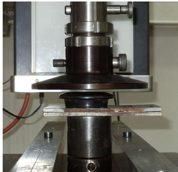
**Slika 6.2.** Eksperimentalne postavke za tlačno ispitivanje
