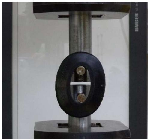
**Slika 6.10. Eksperimentalne postavke za vlačno ispitivanje**
