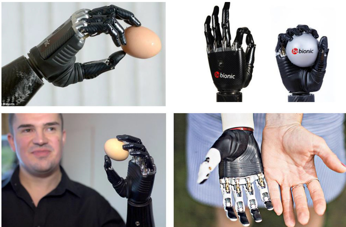
Slika 3.7. Proteza za podlakticu BeBionic [11]
