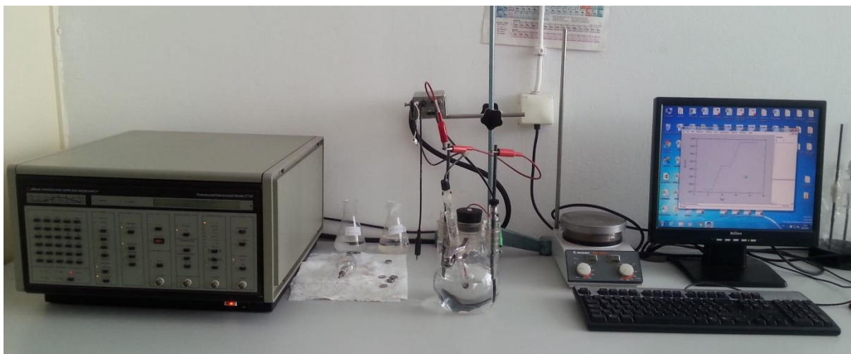
Slika 22. Ispitna oprema za elektrokemijska DC ispitivanja
