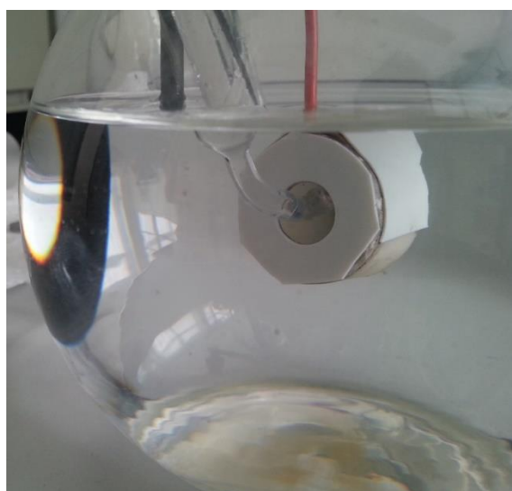
Slika 25. Radna elektroda uronjena u 3,5% NaCl pri sobnoj temperaturi
