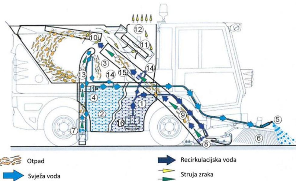
Slika 5: Dijelovi kompaktne vakuumske čistilice
