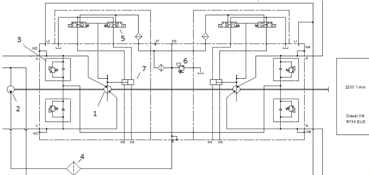
Slika 27: Hidraulička shema aksijalno-klipne pume (EDC)
