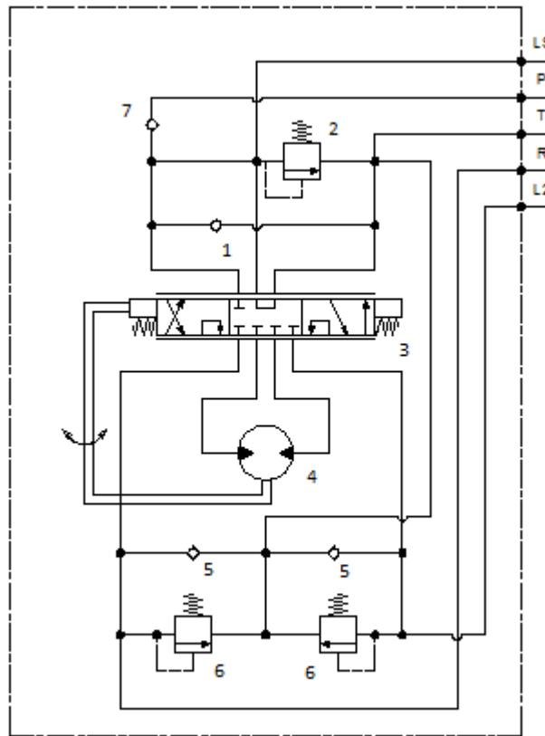
**Slika 10: Hidraulička shema upravljačke jedinice**
