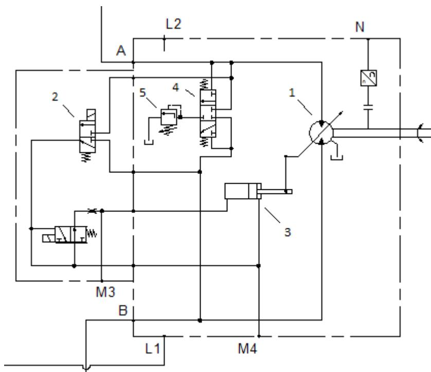
Slika 28: Hidraulička shema aksijalno-klipnog motora s električnim upravljanjem
