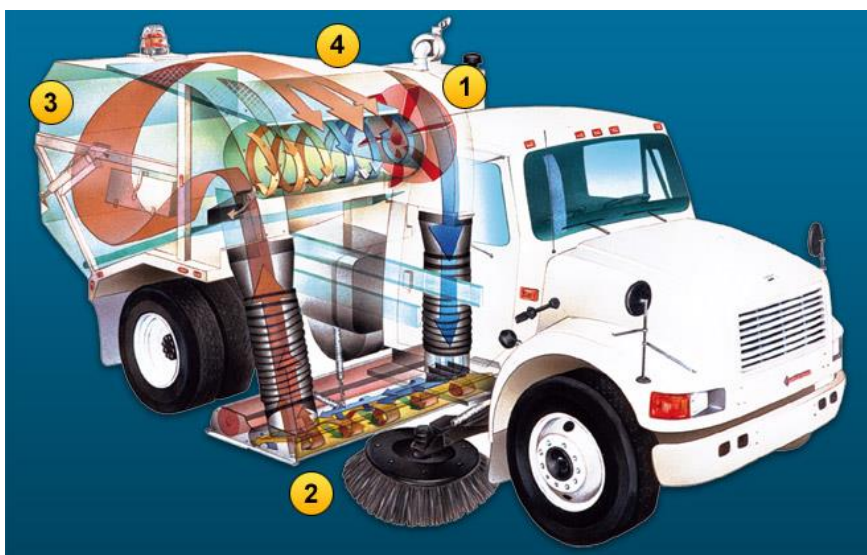
Slika 3: Čistilica s regenerativnim zrakom [3]
