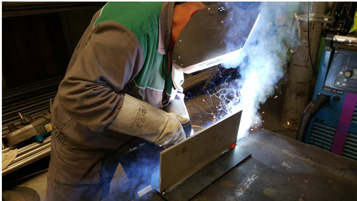
Slika 21. Zavarivanje uzoraka kutnog spoja
