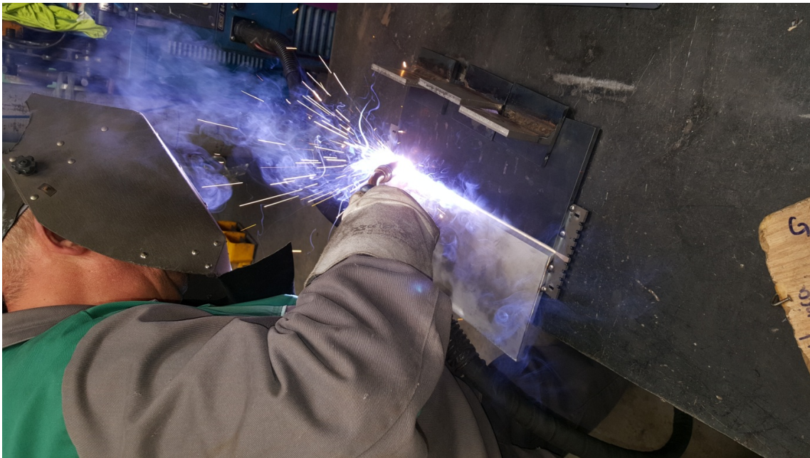
Slika 22. Zavarivanje korijena zavora sučeljenog spoja
