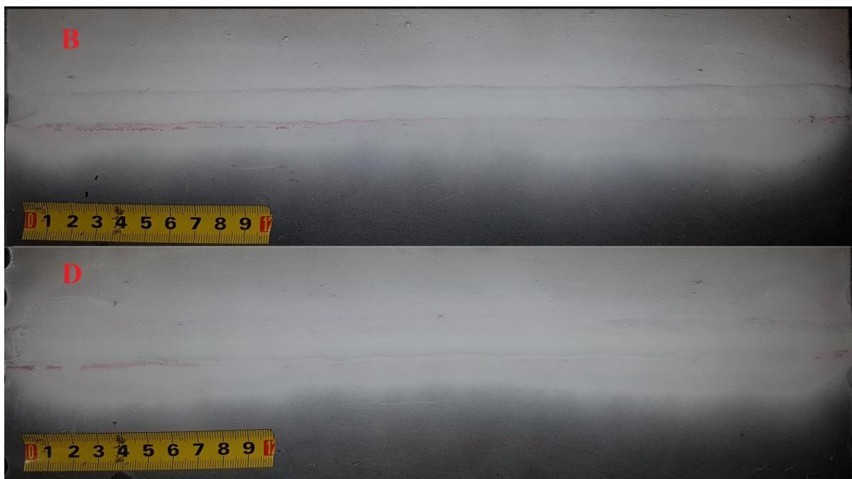
Slika 24. Uzorci sučeljenog spoja nakon ispitivanja penetrantima, gornji - B, donji - D
