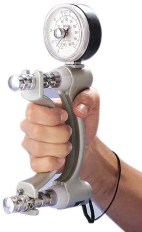
Slika 19. Mjerenje snage stiska hidrauličnim dinamometrom [18]
