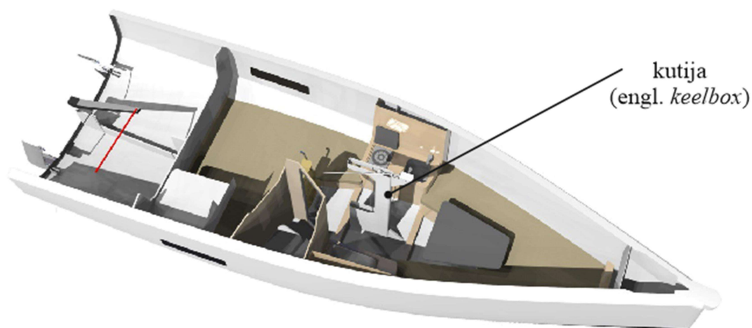
Slika 3. Presjek jedrilice s kutijom za uvlačivu kobilicu
