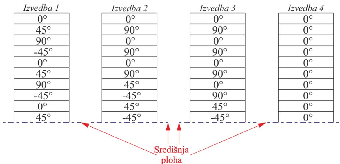
Slika 6.8. Raspored slojeva za različite izvedbe oplate debljine 8 mm
