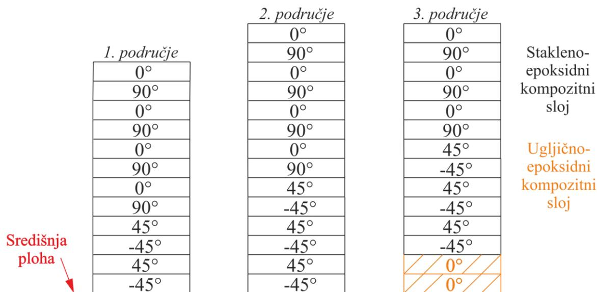
Slika 6.14. Raspored slojeva za konačnu izvedbu kompozitne oplata
