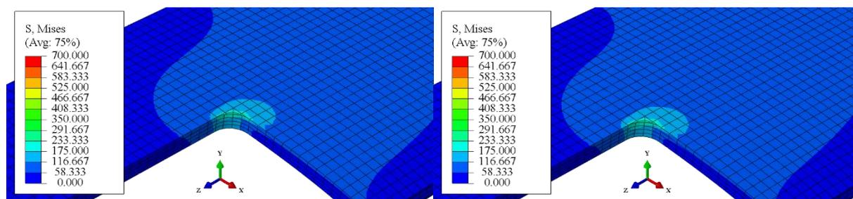
**Slika 5.11. Ekvivalentno naprezanje prema von Misesu (u MPa) na podmodelu sa zaobljenjem oplata kobilice debljine 8 mm kod nazivnog opterećenja 5000 N dobiveno linearnom (lijevo) i nelinearnom (desno) analizom**
