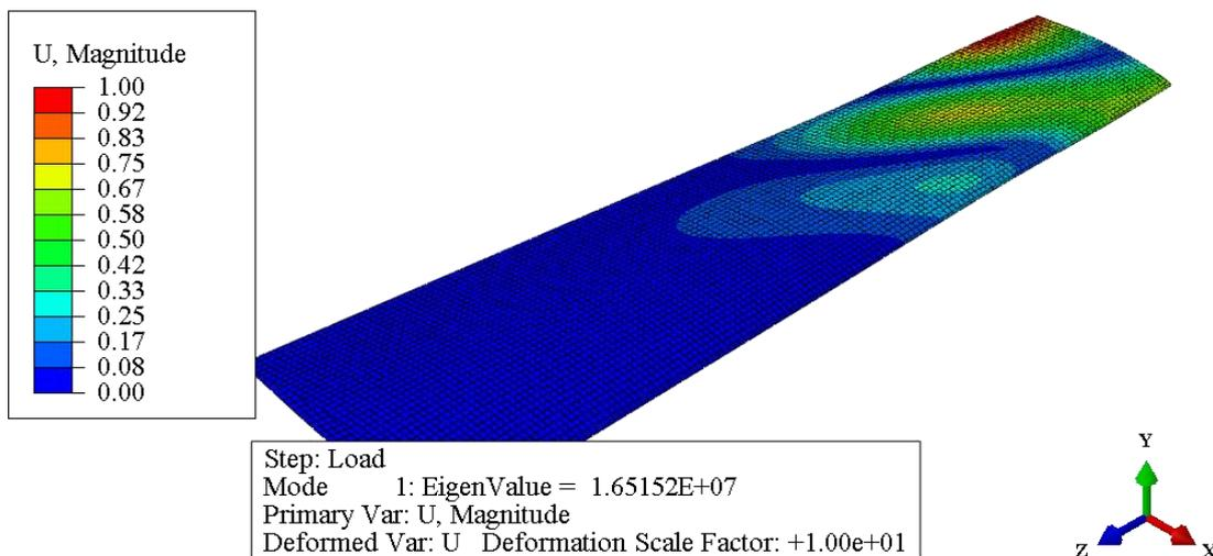
**Slika 6.19.** Prva forma gubitka stabilnosti kod trećeg načina opterećivanja kompozitne oplate
