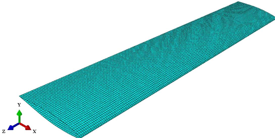
**Slika 6.3. Kompozitna izvedba oplata kobilice diskretizirana s 10584 četverokutnih ljuskastih KE drugog reda (S8R5)**
