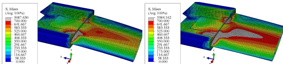
**Slika 5.31. Ekvivalentno naprezanje prema von Misesu (u MPa) na podmodelu kobilice sa zaobljenjima kod opterećenja 20000 N dobiveno linearnom (lijevo) i nelinearnom (desno) analizom**
