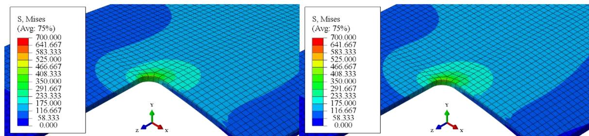
**Slika 5.10. Ekvivalentno naprezanje prema von Misesu (u MPa) na podmodelu sa zaobljenjem oplata kobilice debljine 4 mm kod nazivnog opterećenja 5000 N dobiveno linearnom (lijevo) i nelinearnom (desno) analizom**
