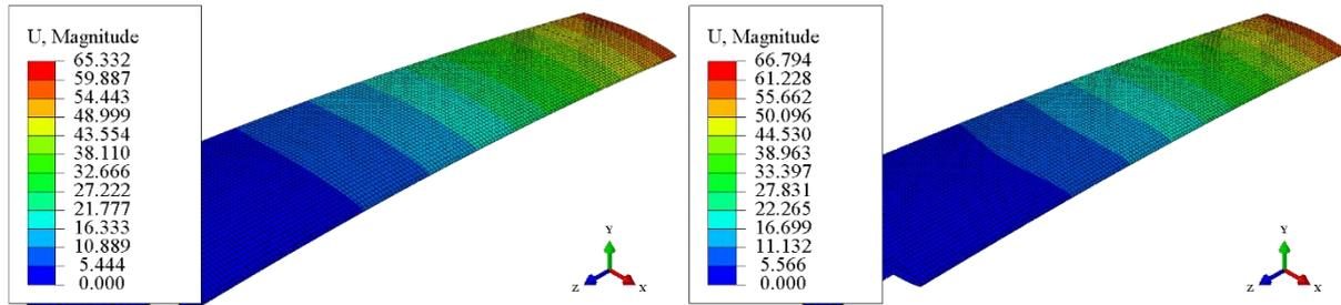
Slika 5.17. Progib (u mm) oplata kobilice debljine 8 mm kod opterećenja 20000 N dobiveno linearnom (lijevo) i nelinearnom (desno) analizom
