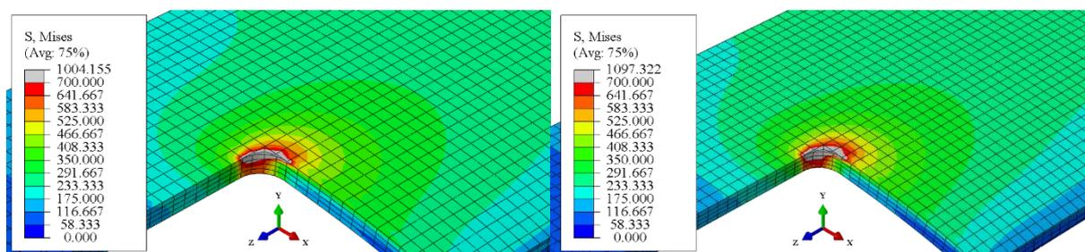
**Slika 5.21. Ekvivalentno naprezanje prema von Misesu (u MPa) na podmodelu sa zaobljenjem oplata kobilice debljine 8 mm kod opterećenja 20000 N dobiveno linearnom (lijevo) i nelinearnom (desno) analizom**
