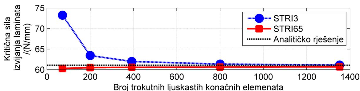
**Slika 4.29. Dijagram konvergencije kritične sile izvijanja lamianta diskretiziranog trokutnim ljuškastim KE**
