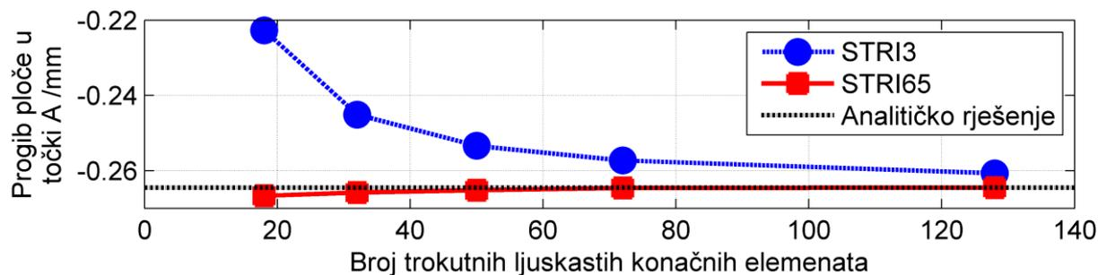
Slika 4.15. Dijagram konvergencije progiba izotropne ploče u točki A diskretizirane trokutnim ljuskastim KE
