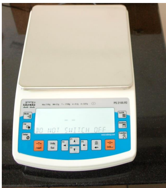
Slika 10. Vaga proizvođača RADWAG tipa PS 2100. R2
