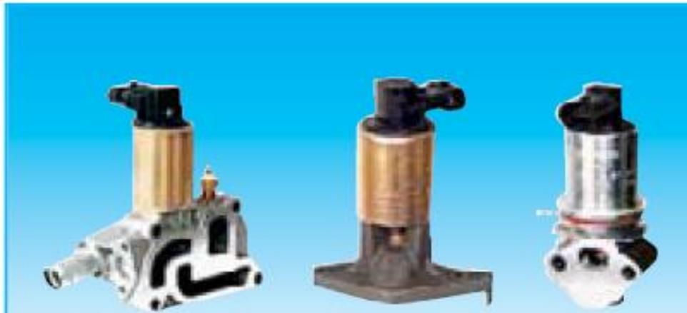
Slika 21. Konstrukcije EGR ventila kod benzinskih motora [6]
