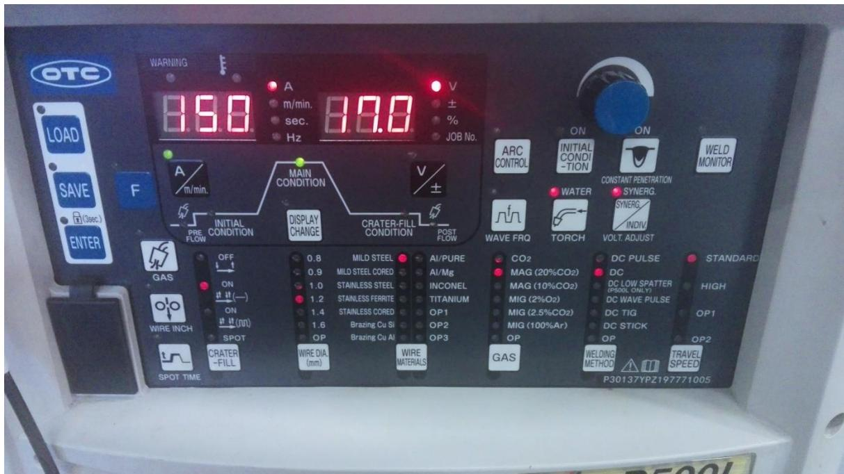
Slika 28. Parametri zavarivanja za konstrukcijski čelik
