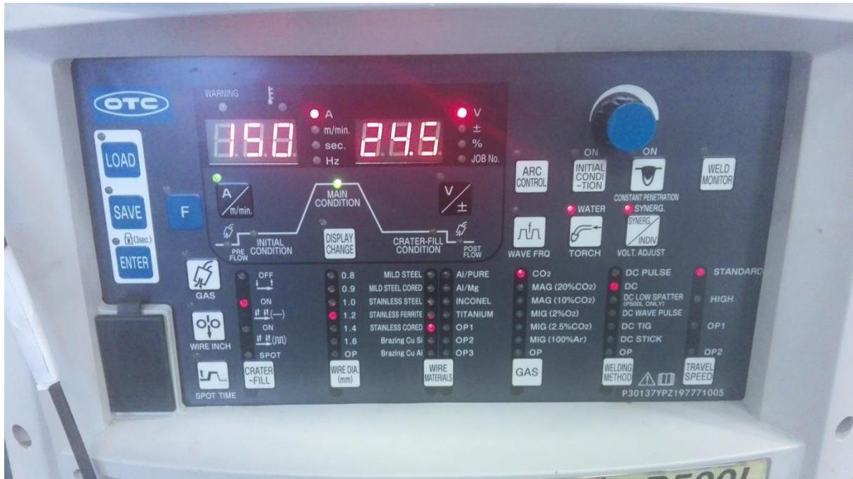
Slika 31. Parametri zavarivanja pri zavarivanju nehrđajućeg čelika praškom punjenom žicom
