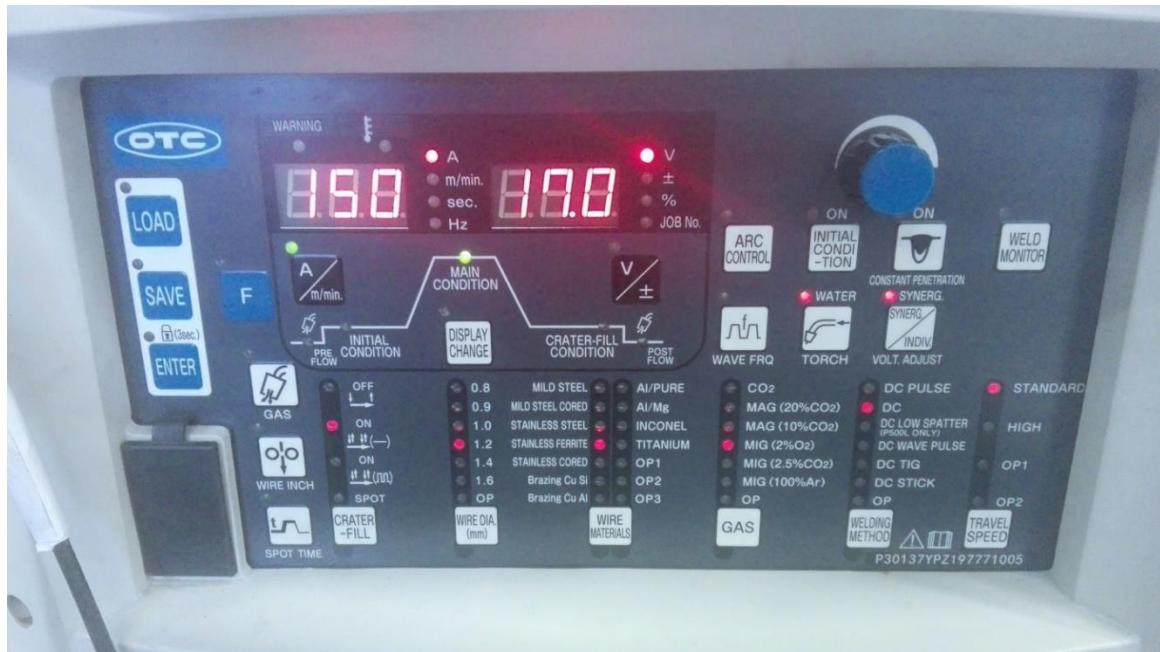
Slika 30. Parametri zavarivanja pri zavarivanju feritnog nehrđajućeg čelika
