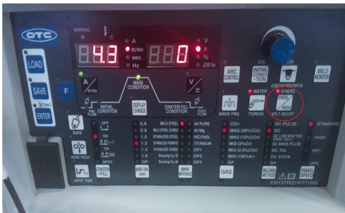
Slika 27. Sučelje za podešavanje načina rada i parametara na izvoru struje OTC Daihen Welbee P500L
