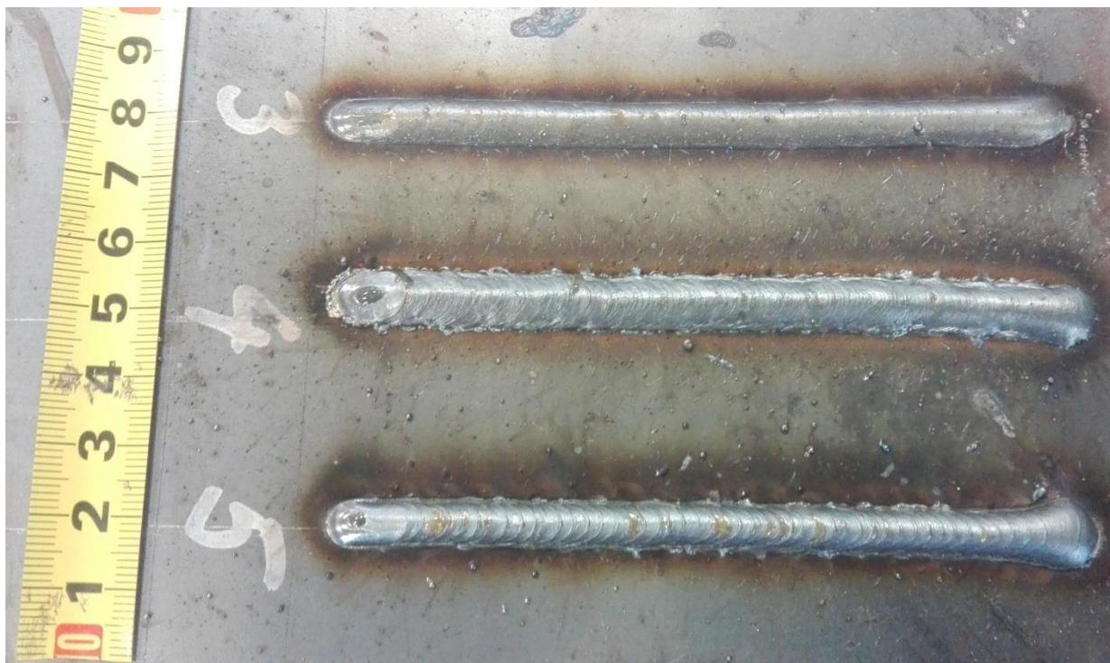
Slika 38. Navari dobiveni primjenom funkcije Arc control
