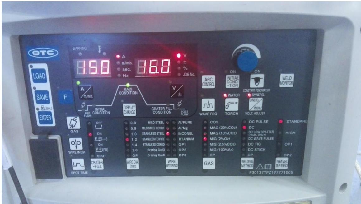
Slika 29. Parametri zavarivanja pri zavarivanju nehrđajućeg čelika
