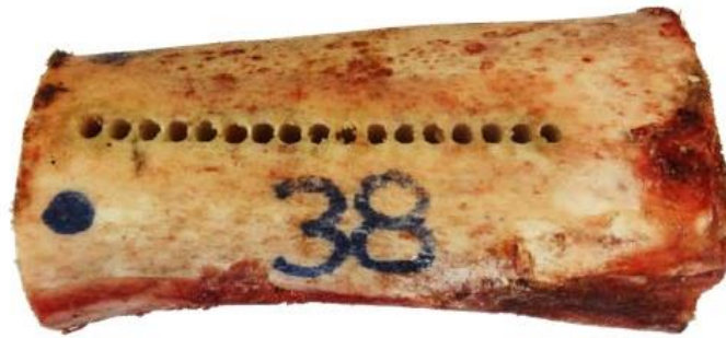
Slika 6. Ispitni uzorak nakon bušenja
