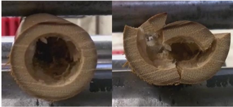
Slika 39. Lom uslijed savijanja uzorak 25-3
