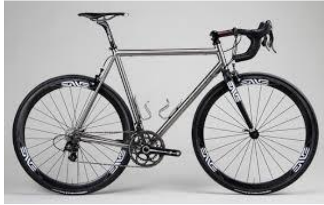
Slika 10. Okvir od titanove legure [23]
