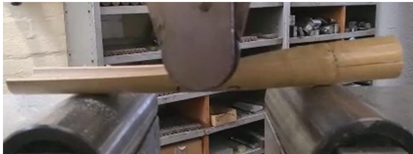
Slika 40. Lom uslijed savijanja uzorak 13-2
