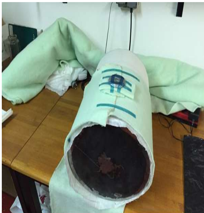
Slika 50. Omotana tkanina za upijanje prekomjerne smole
