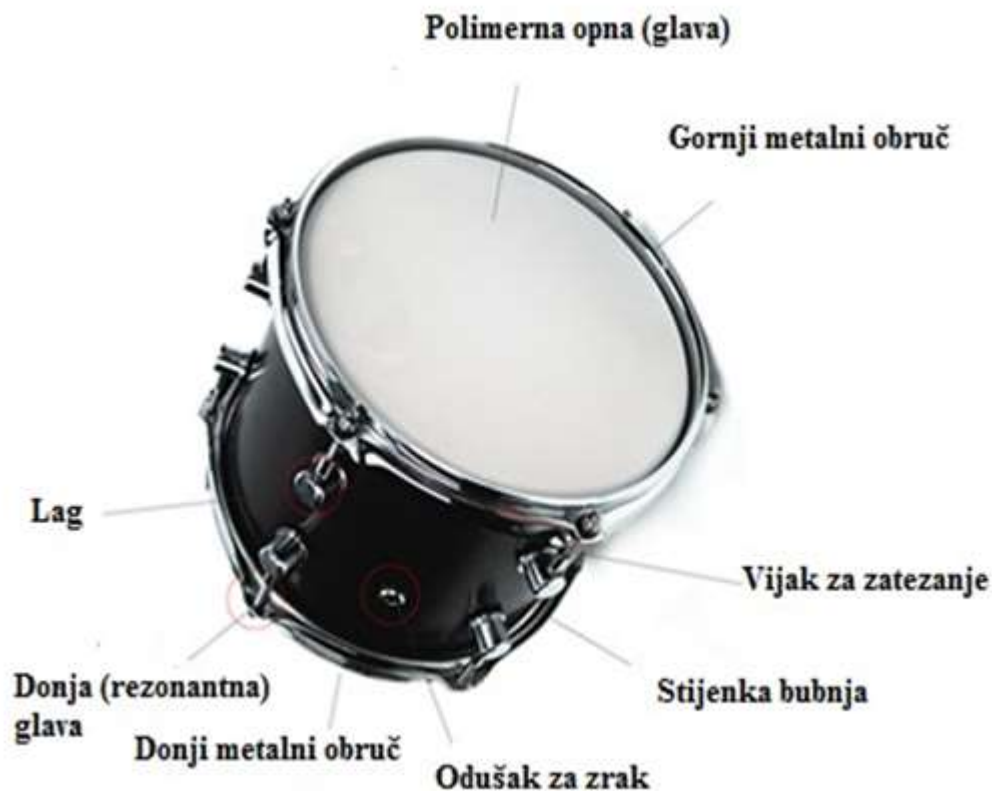
Slika 7. Dijelovi tam-tam bubnja [7]
