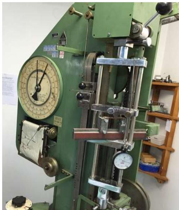
**Slika 69. Trotočkasto savojno ispitivanje na kidalici**
