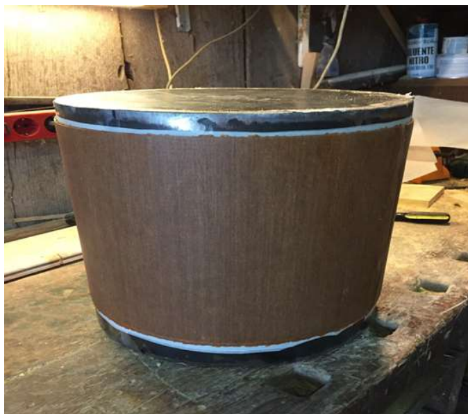
Slika 60. Toplinski obrađena kompozitna stijenka
