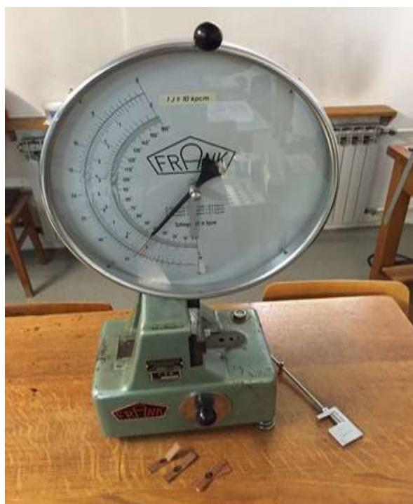
Slika 73. Ispitivanje žilavosti na Charpyjevom batu
