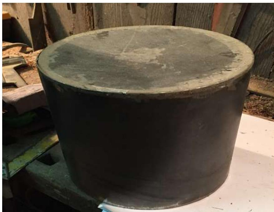
**Slika 43. Kalup od čeličnog lima**
