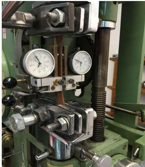
**Slika 65. Kidalica na kojoj je izvršeno vlačno ispitivanje**
