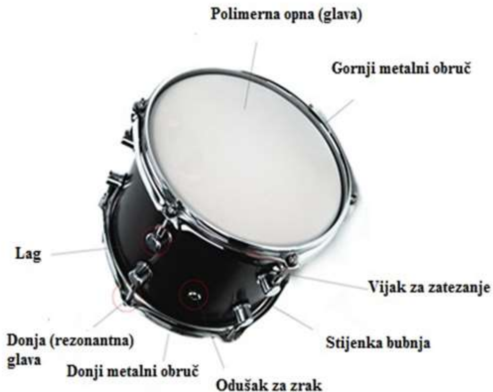
Slika 7. Dijelovi tam-tam bubnja [7]
