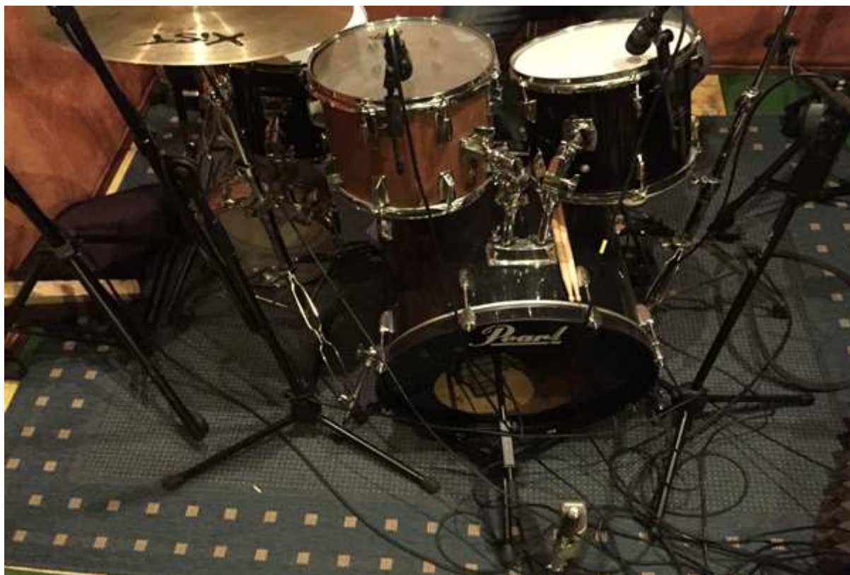
Slika 74. Montirani mikrofoni na drvenom i kompozitnom bubnju
