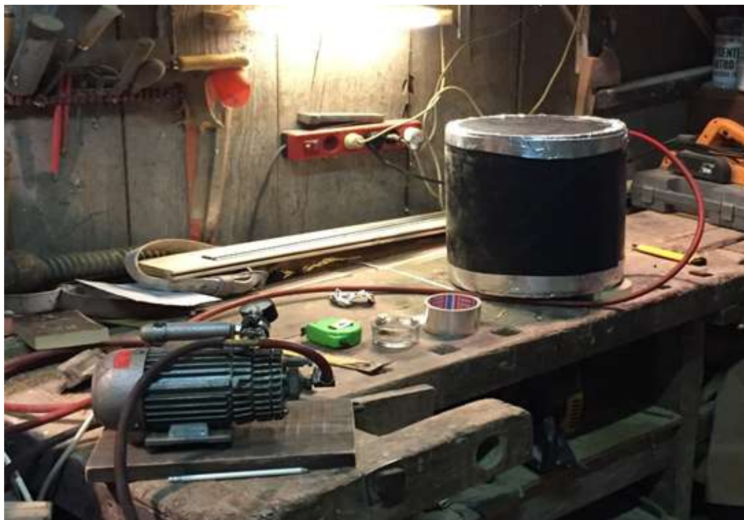
Slika 58. Oprema za podtlačno oblikovanje
