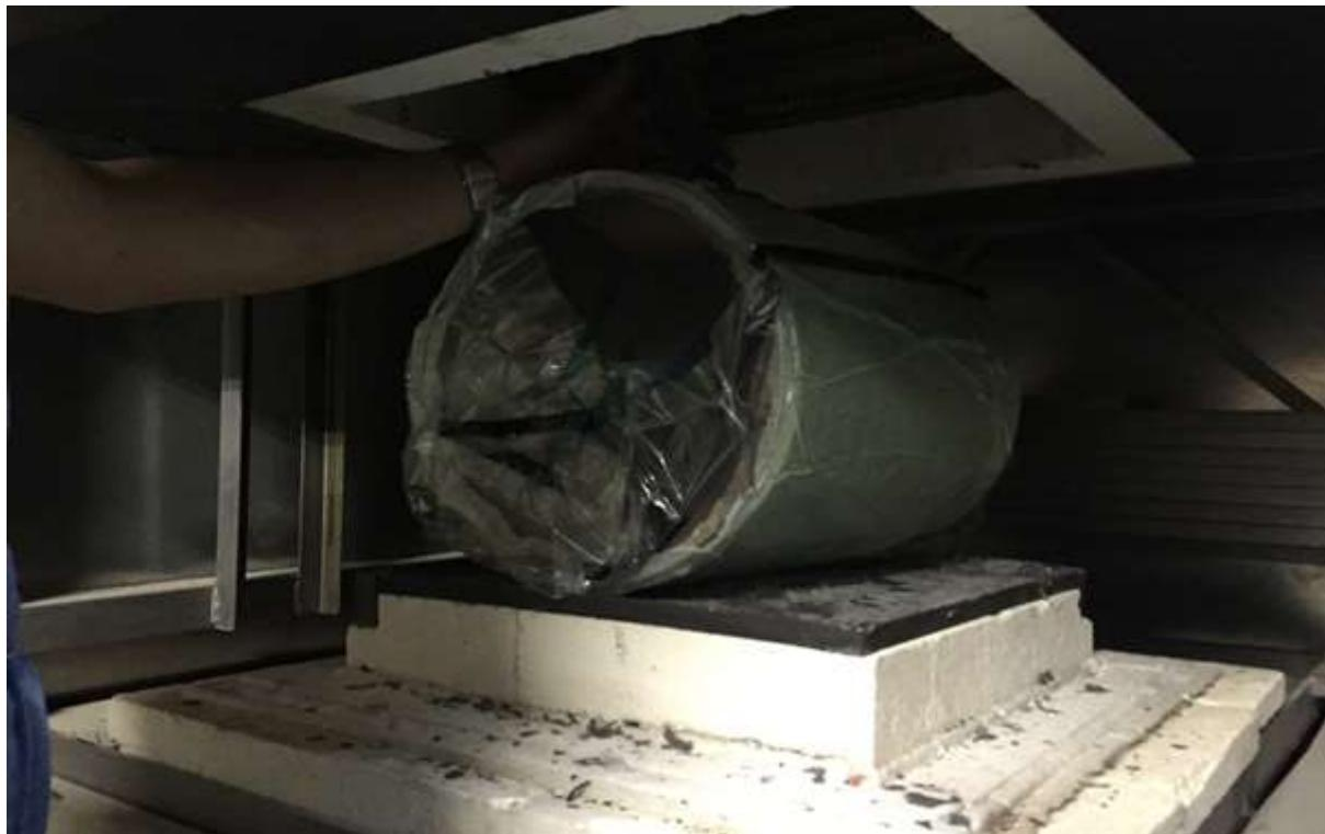
**Slika 53. Polaganje omotanog kalupa u peć**
