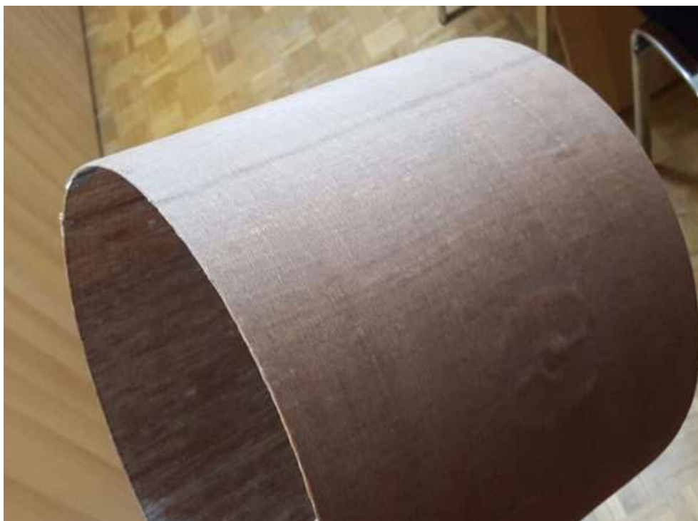
Slika 55. Dobivena stijenka bubnja od lanenog kompozita
