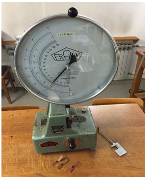
Slika 73. Ispitivanje žilavosti na Charpyjevom batuu
