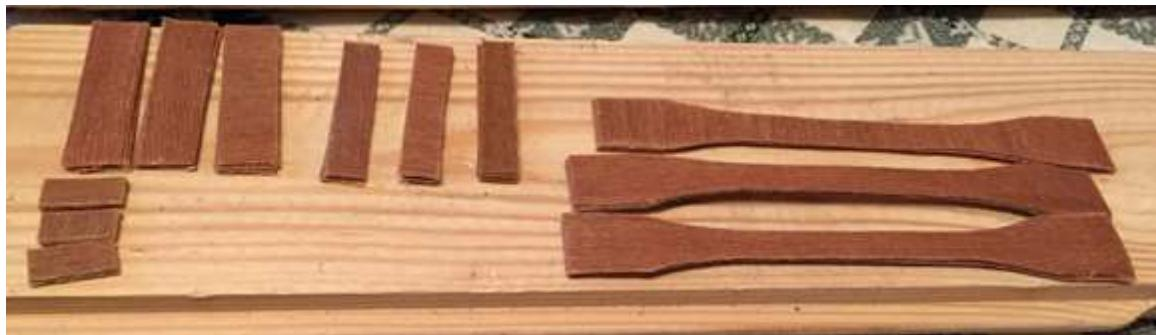
Slika 64. Izrezane epruvete
