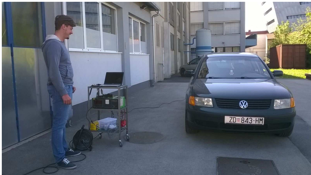
Slika 6.1 Mjerenje sastava ispušnih plinova na automobilu Volkswagen Passat
