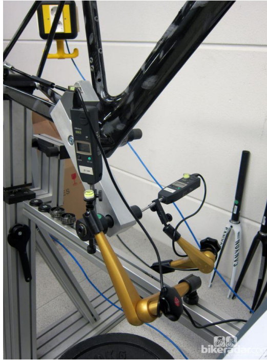
Slika 18 - Mjerenje pomaka tokom i nakon ispitivanja - Canyon Factory [9]
