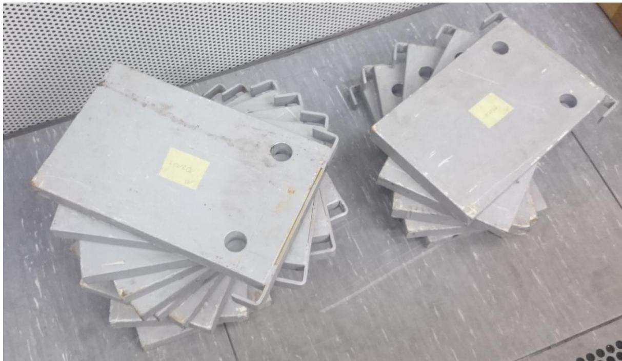
Slika 8.13 Priručni utezi upotrijebljeni u postupku preliminarnog umjeravanja
