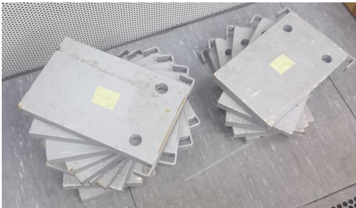
Slika 8.13 Priručni utezi upotrijebljeni u postupku preliminarnog umjeravanja
