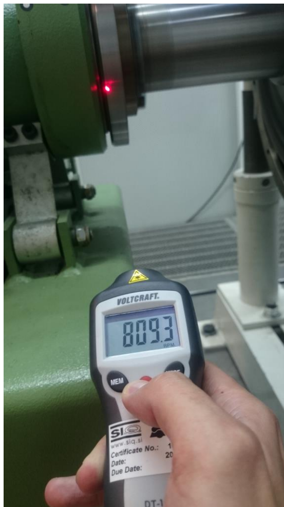
Slika 8.23 Mjerenje brzine vrtnje uređajem Voltcraft DT-10L
