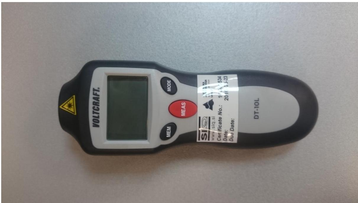
Slika 8.21 Uredaj za mjerjenje brzine vrtnje Voltcraft DT-10L
