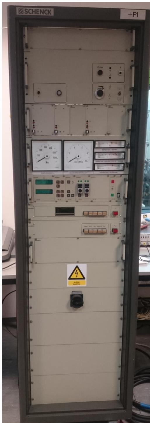
Slika 8.7 Upravljački ormar hidrauličke kočnice
