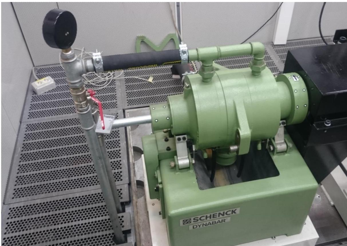
Slika 8.1 Hidraulička kočnica SCHENCK tip D 400 – 1e
