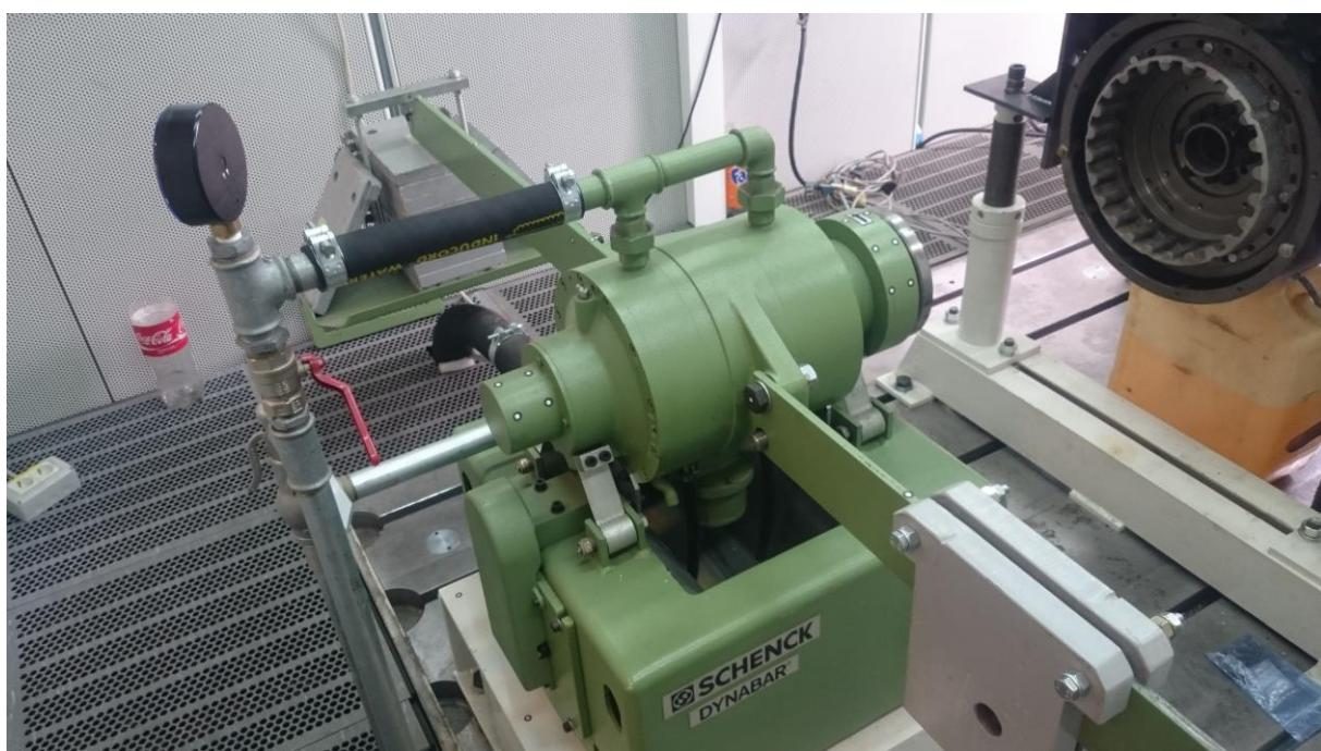
Slika 8.14 Detalji iz postupka umjeravanja momenta kočnice utezima
