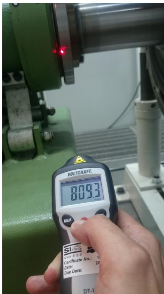
Slika 8.23 Mjerenje brzine vrtnje uređajem Voltcraft DT-10L
