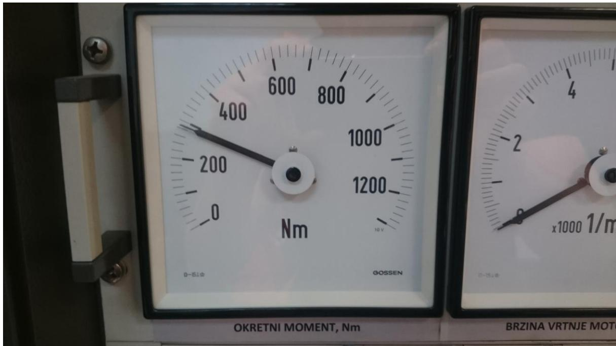
Slika 8.9 Analogni prikaz momenta na upravljačkom ormaru kočnice
