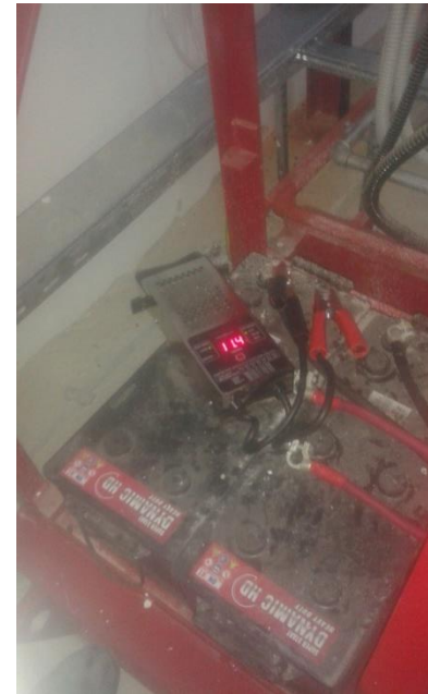
Slika 27. Ispitivanje napona akumulatora voltmetrom
