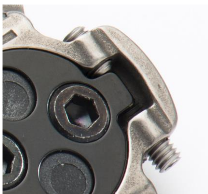
Slika 19. Podešavanje slobode gibanja vijkom [17]
