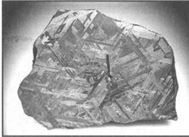
Slika 2. Widmanstättenova struktura iz meteorita u Australiji
