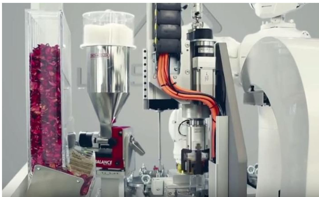
Slika 67. Doziranje dodatnog rasutog materijala [14]
