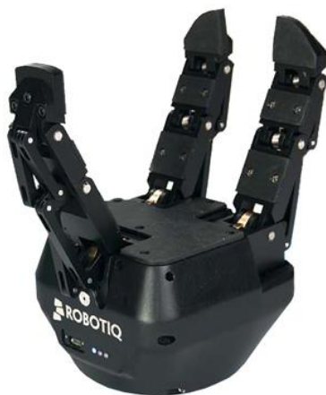
Slika 80. Prilagodljiva robotska hvataljka s tri osjetljiva prsta [17]
