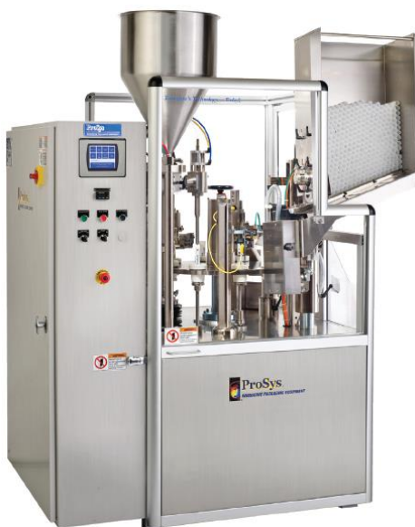
Slika 81. Stroj za automatsko dodavanje ambalaže ProSys RT 60 [19]
