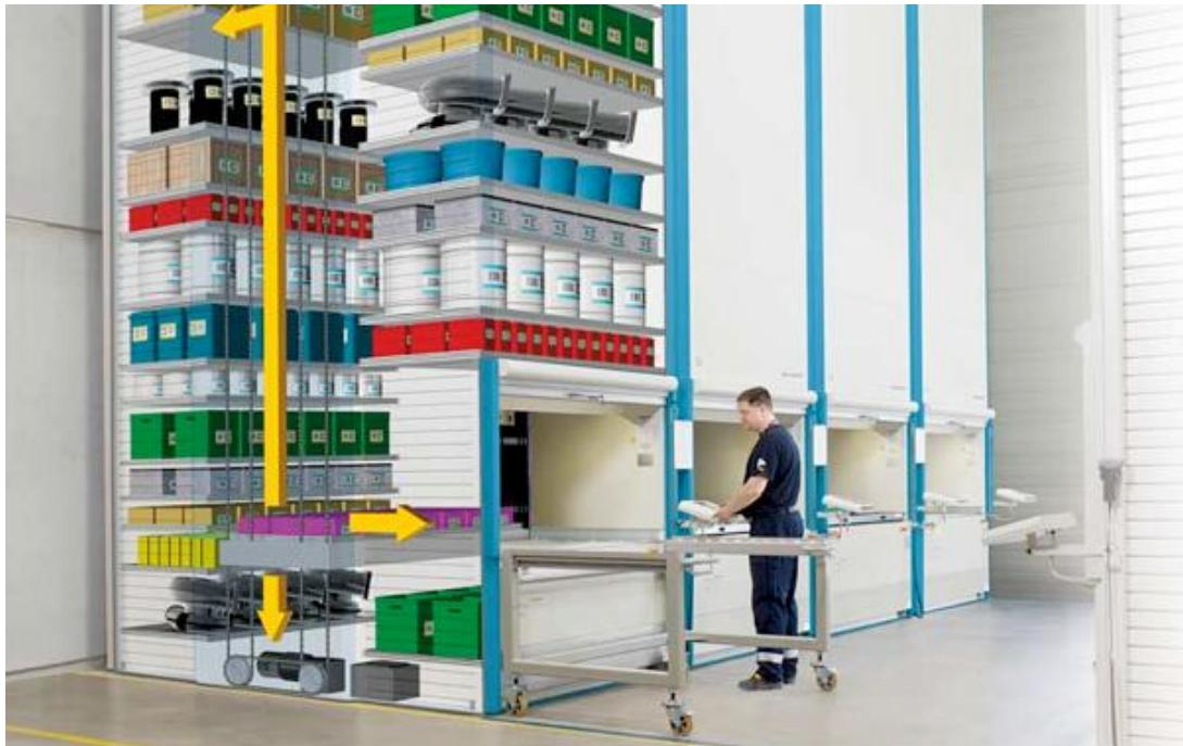
Slika 13. Sustav s 4 vertikalna podizna modula
