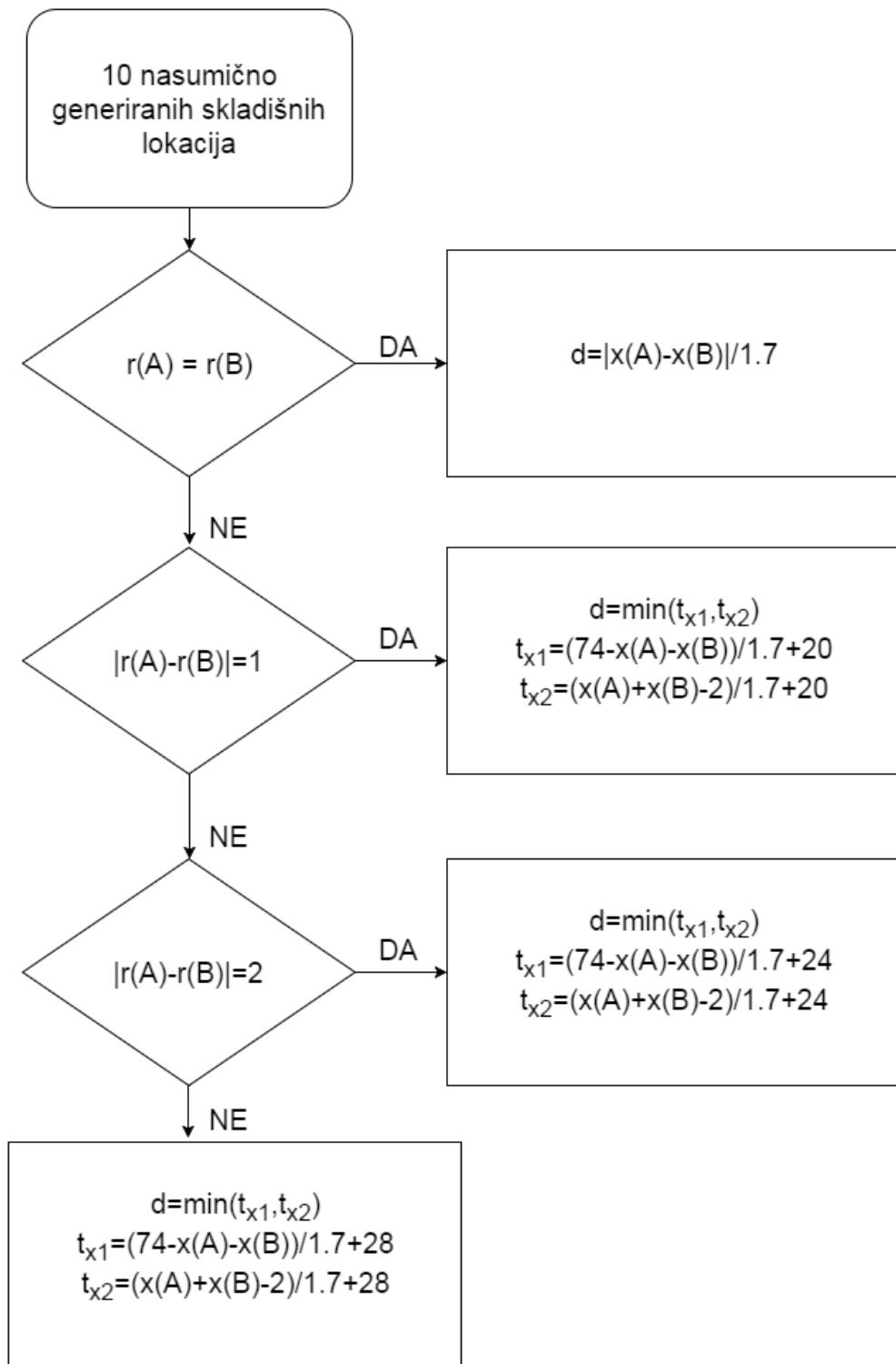
**Slika 42.** Postupak određivanja vremenskih udaljenosti kod kretanja u horizontalnoj ravni između dviju skladišnih lokacija
