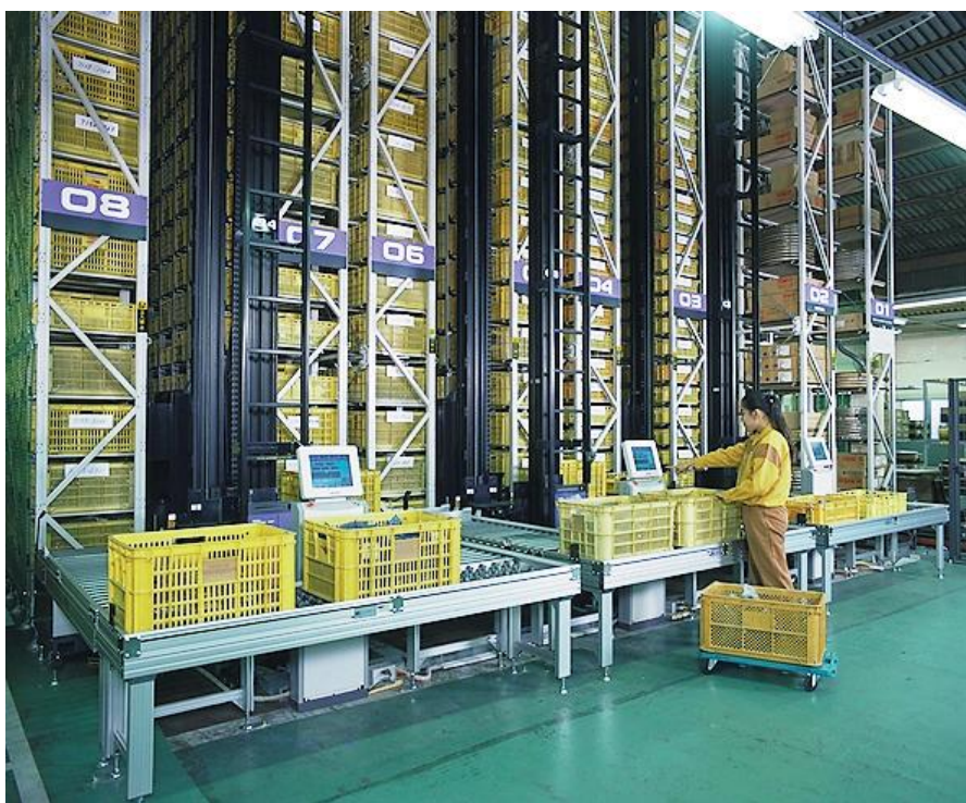
Slika 15. Skladišni sustav s 3 mini-load dizalice
