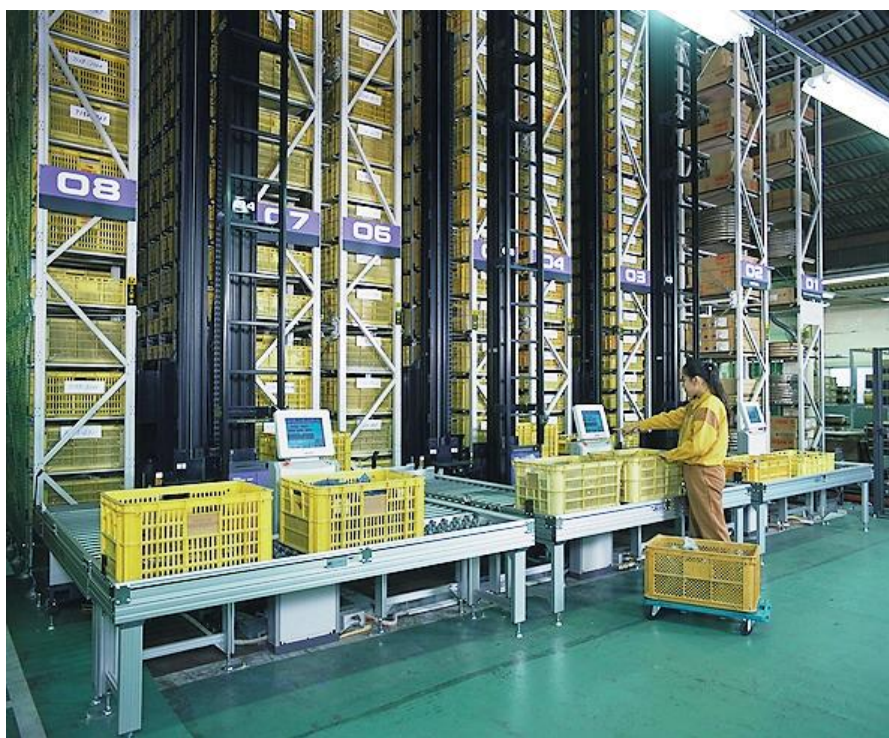
Slika 15. Skladišni sustav s 3 mini-load dizalice
