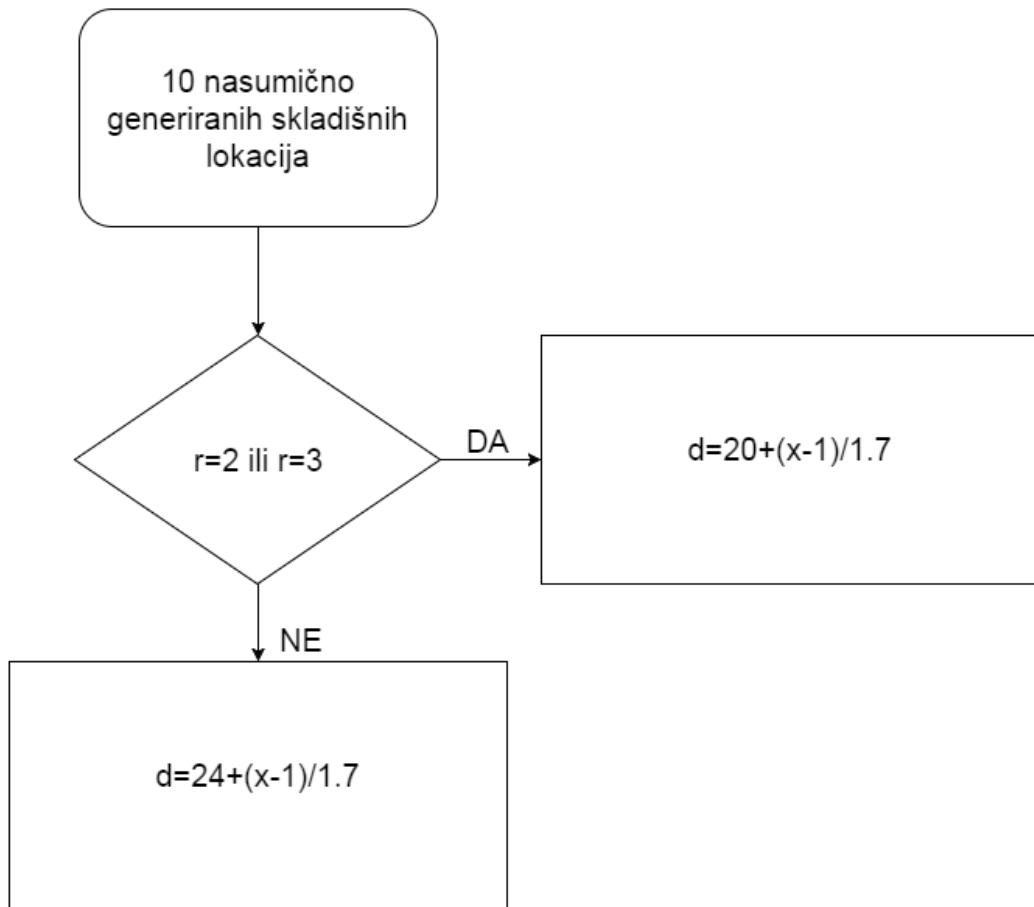
**Slika 40.** Postupak određivanja vremenskih udaljenosti kod kretanja u horizontalnoj ravnini između pretvarne stanice i neke skladišne lokacije
