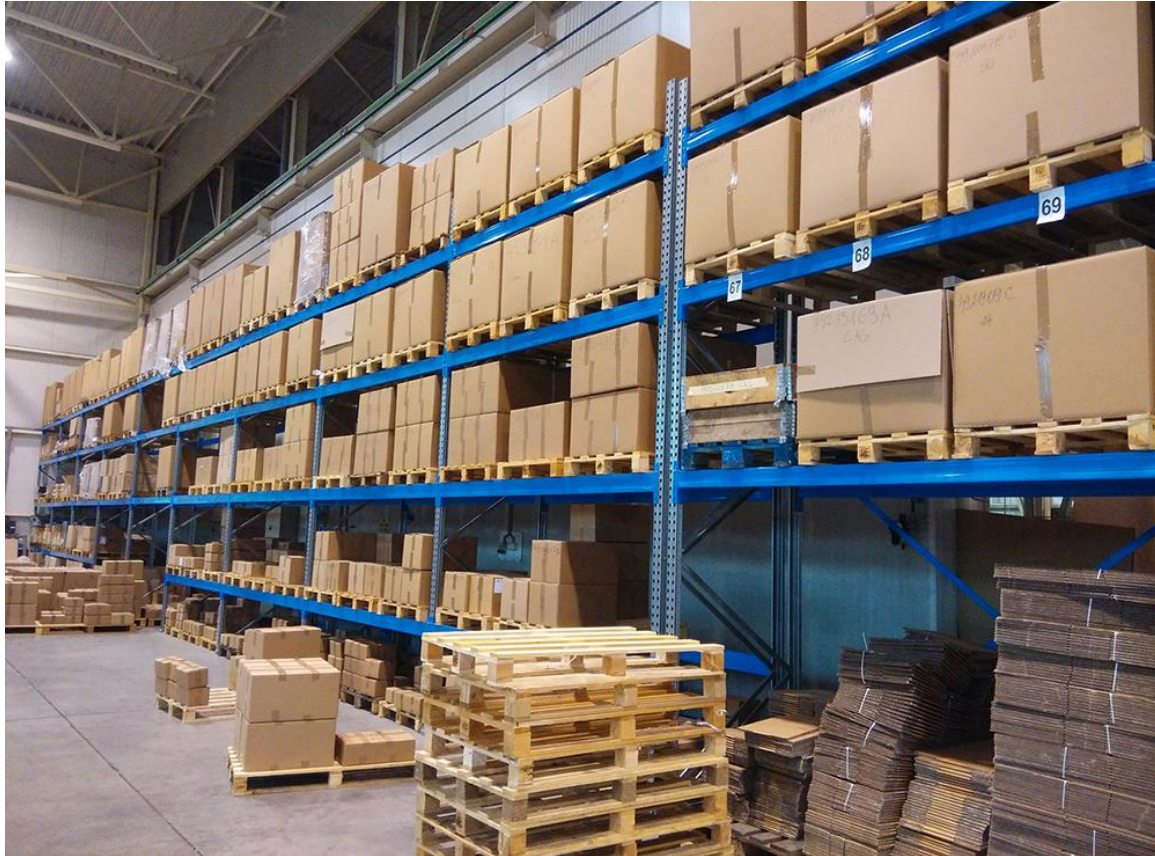
Slika 2. Klasična izvedba skladišta s paletnim regalima
