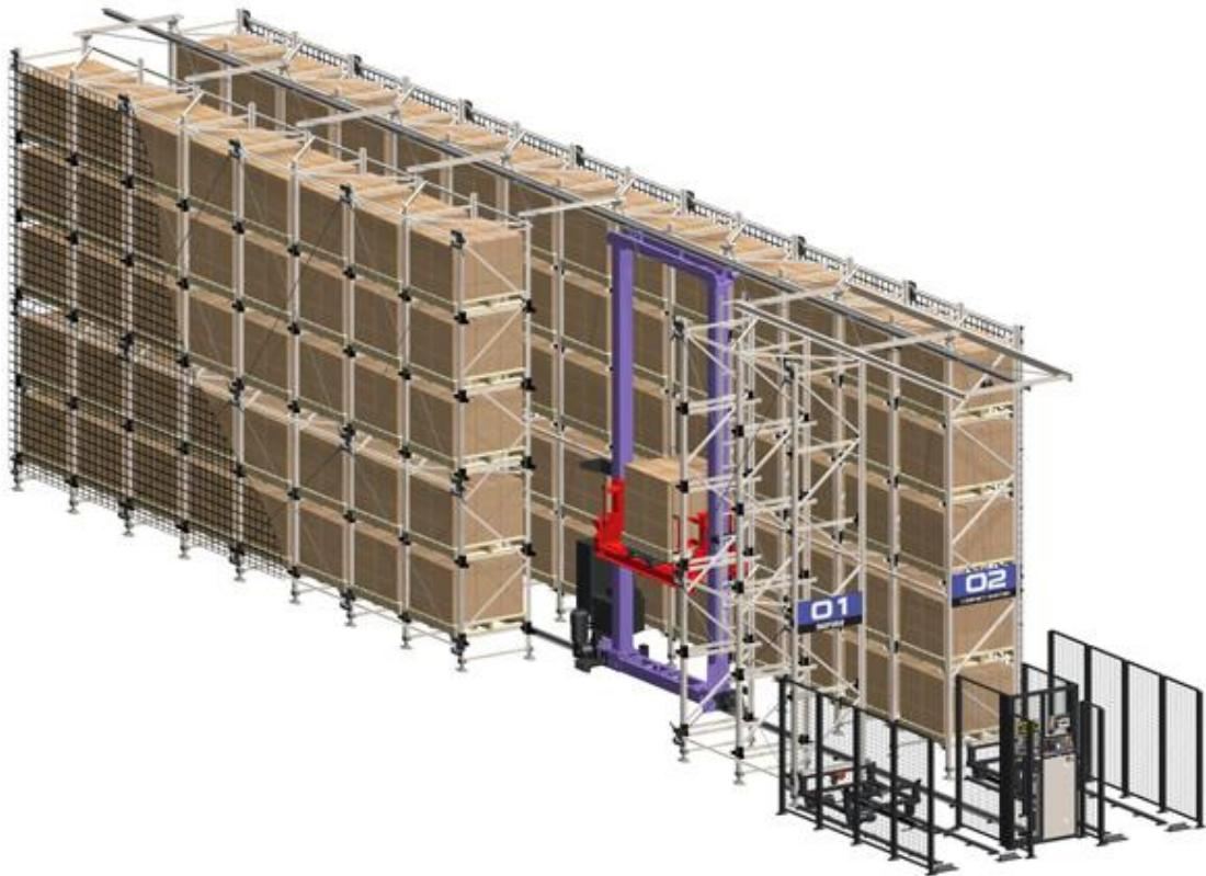
**Slika 16. Klasična konfiguracija unit-load AS/RS sustava**
