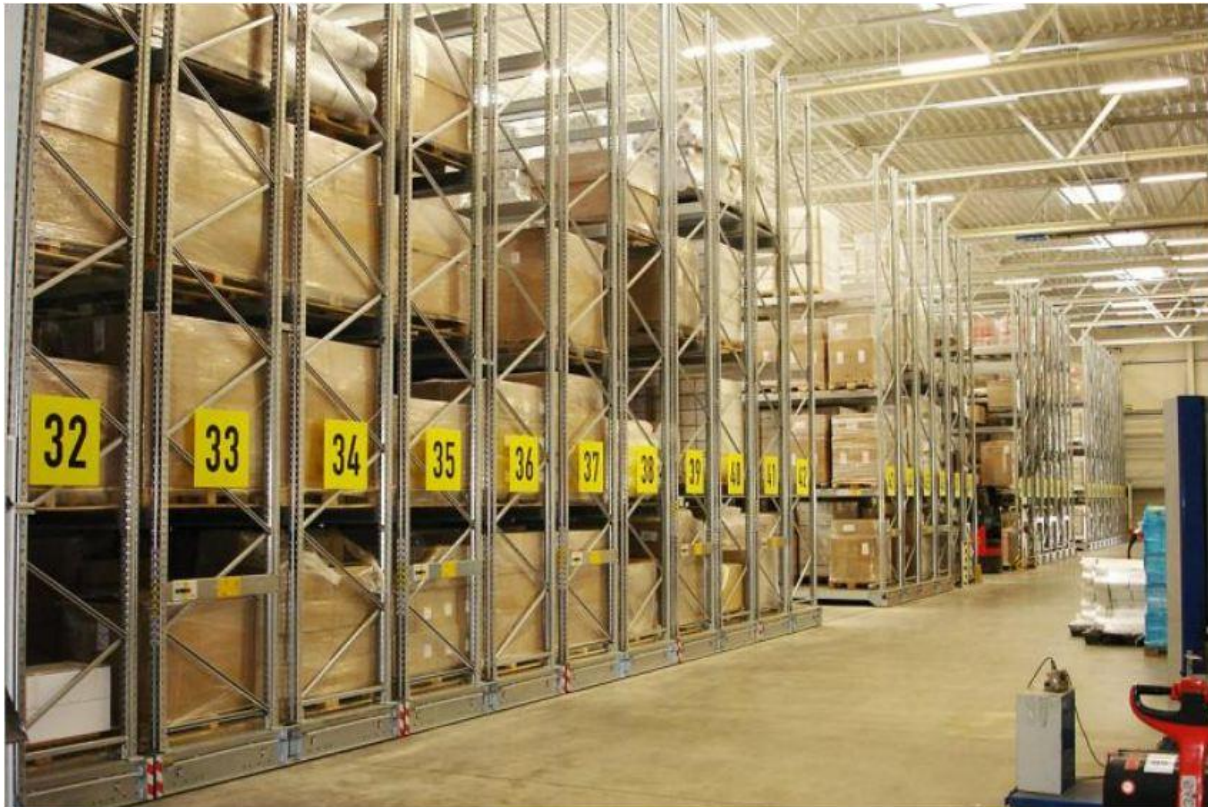
Slika 8. Skladište s prijevoznim paletnim regalima
