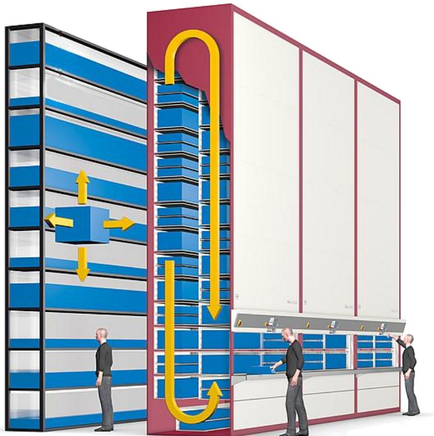
**Slika 12.** Usporedba klasičnog poličnog regala s policama i vertikalnog karusela
