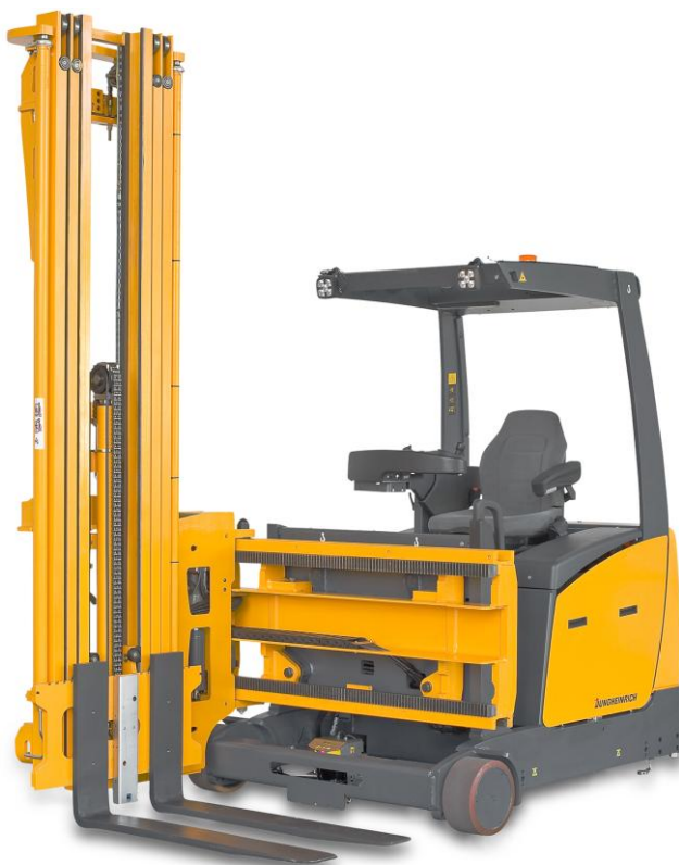
Slika 32. Viličar s fiksnom kupolom Jungheinrich EFX 410/413
