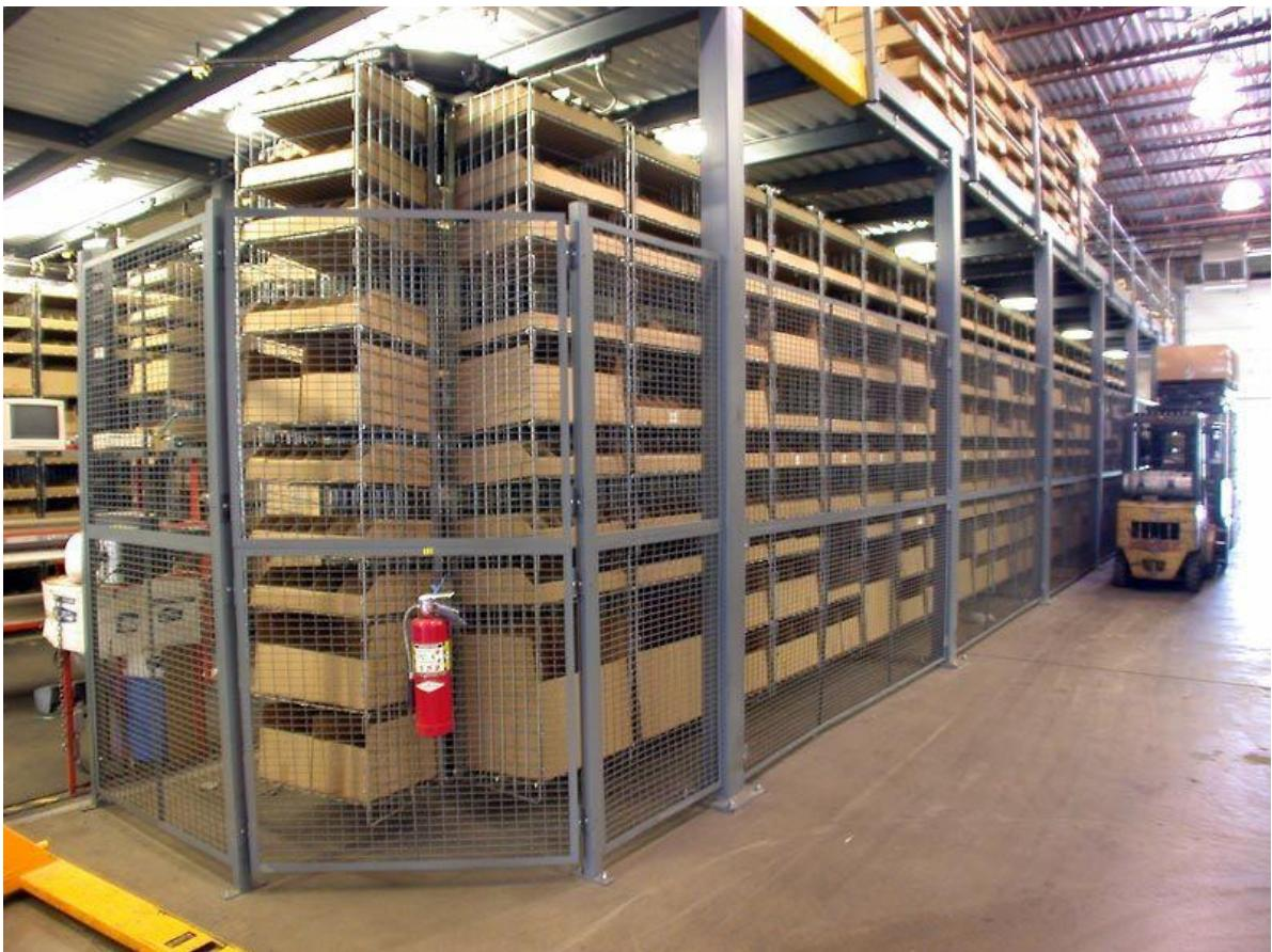
**Slika 11. Automatizirani horizontalni karusel zaštićen ogradom**
