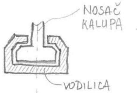
**Slika 22: Vodilica nosača kalupa (koncept #2)**
