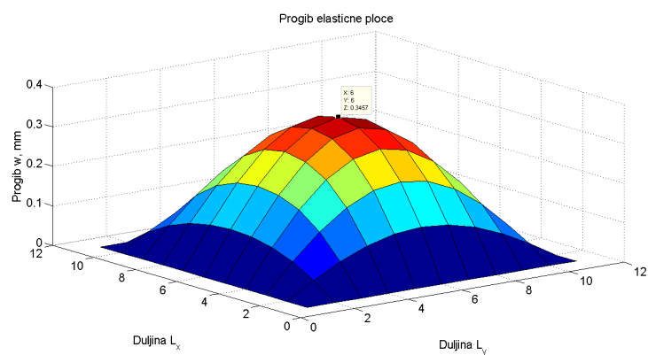
Slika 4.11: Progib: w = 0,345653 mm (100 elemenata)
