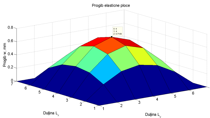
Slika 3.7: Progib: w = 0,7149 mm ( 5 \times 5 )
