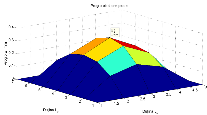
Slika 4.9: Progib: w = 0,34595 mm (24 elemenata)
