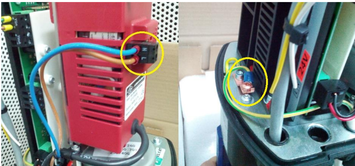
Slika 3.10. Spajanje napajanja na transformator.
