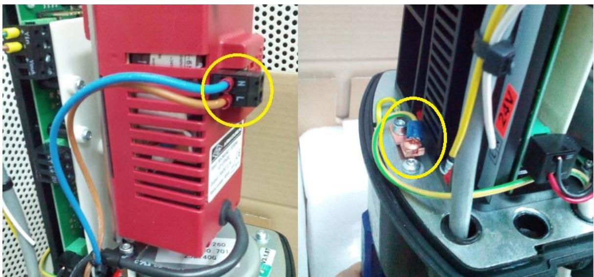
Slika 3.10. Spajanje napajanja na transformator.
