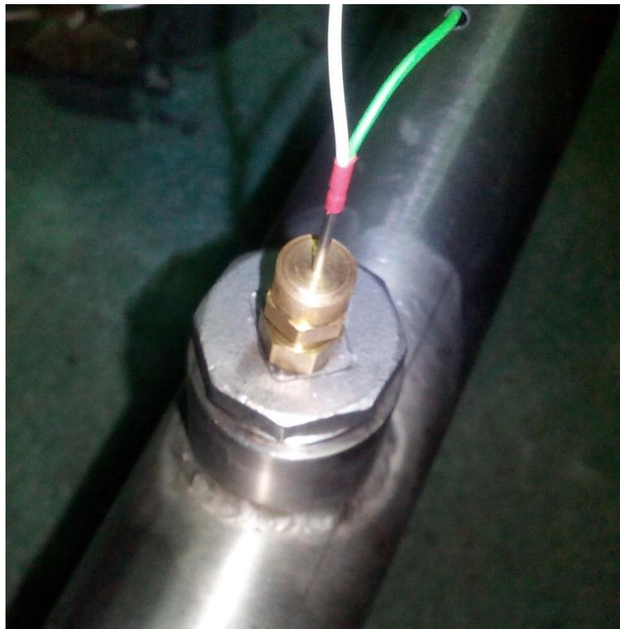
Slika 4.5. Prikaz spojenog termopara na cijevi.
