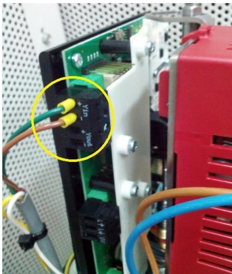
Slika 3.11. Spajanje signalnog kabla na aktuator.
