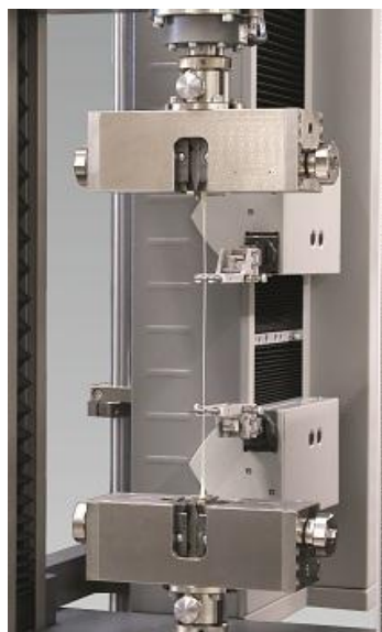
Slika 10. Mjerenje „sensor arm“ ekstenzometrom [48]
