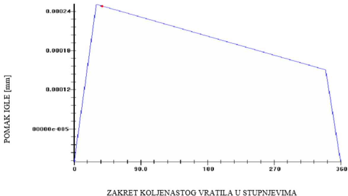
Slika 17 Prikaz podizanja igle u milimetrima u ovisnosti o kutu zakreta koljenastog vratila
