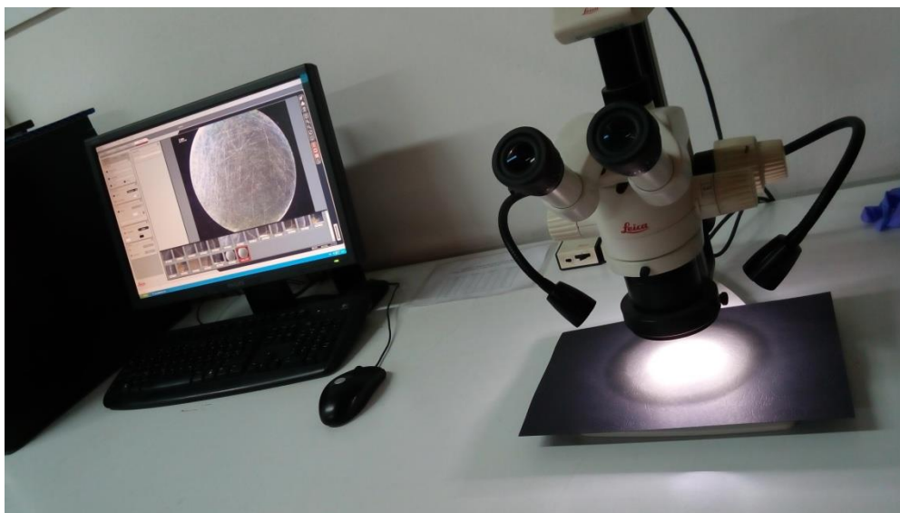
Slika 23. Stereomikroskop model Leica MZ6 sa snimkom uzorka u Leica Application programu
