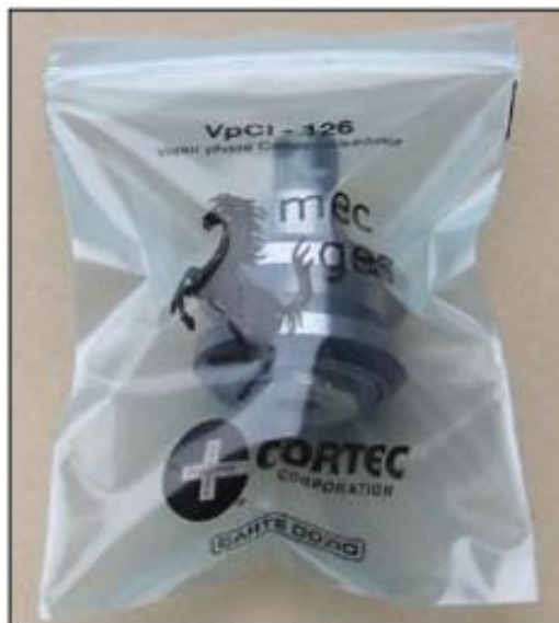
Slika 15. Privremena zaštita dijela motora VCI plastičnom vrećicom [12]
