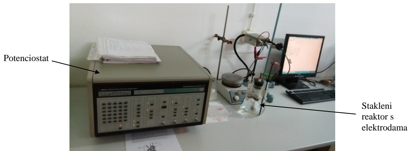
Slika 20. Potenciostat i ispitna ćelija
